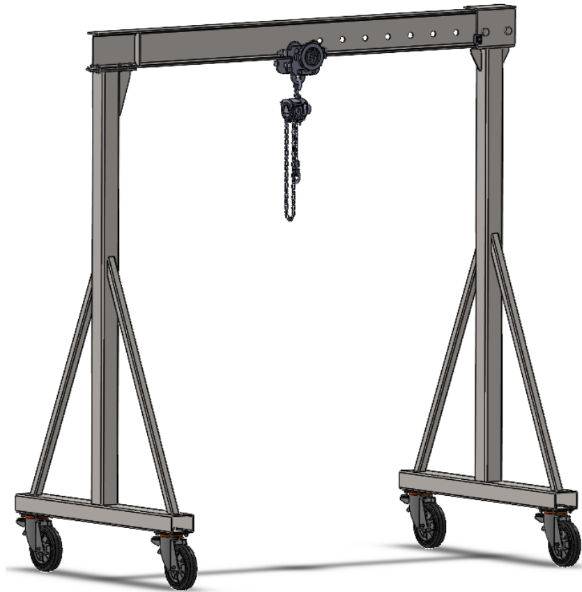
Slika 34. Model pomičnog okvira za podizanje u programskom paketu SolidWorks
