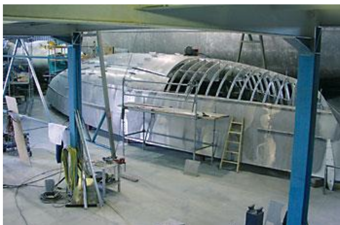
Slika 5. Oplata trupa broda izrađena od aluminija[14]
