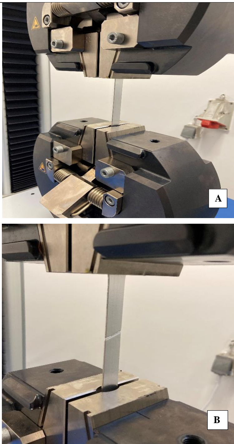
Slika 49. Epruveta učvršćena na kidalici prije kidanja (A) i nakon kidanja (B)
