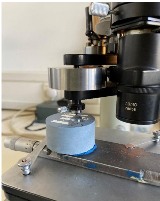
Slika 42. Mjerenje mikrotvrdoće po Vickersu HV0,2
