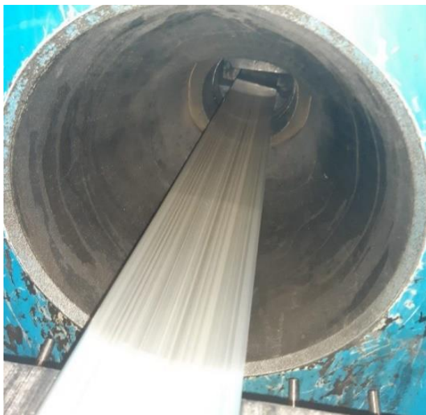
Slika 20. Konačni oblik profila na izlazu alata
