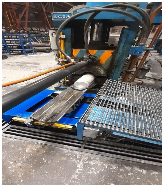
Slika 19. Odsijecanje trupca aluminija
