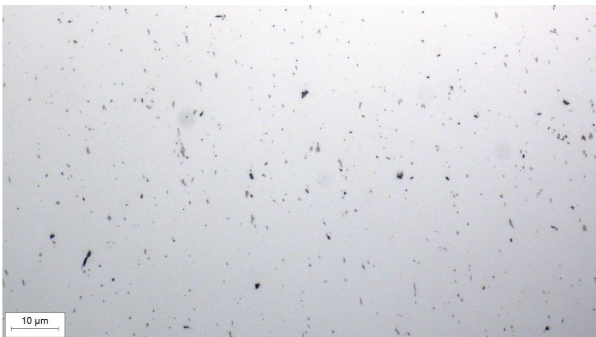
Slika 34. Mikrostruktura legure 6063 snimljena pri povećanju 500× u poliranom stanju
