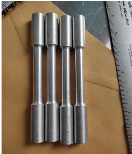
Slika 17. Epruvete za statičko vlačno ispitivanje
