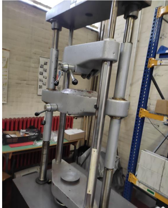
Slika 19. Hidraulička kidalica WEB WPM
