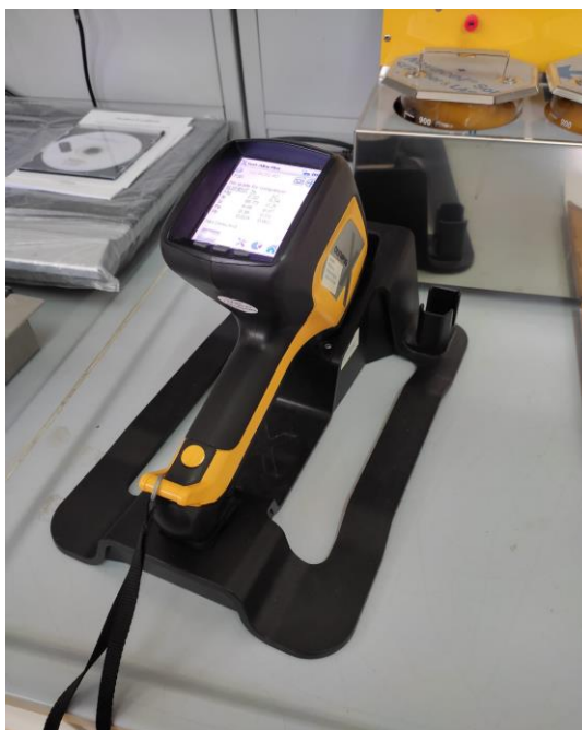
Slika 12. HHXRF-ručna rendgenska fluorescencija
