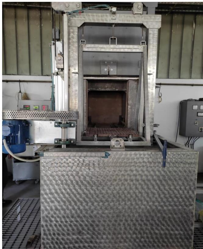
Slika 15. Peć za toplinsku obradu aluminijskih legura
