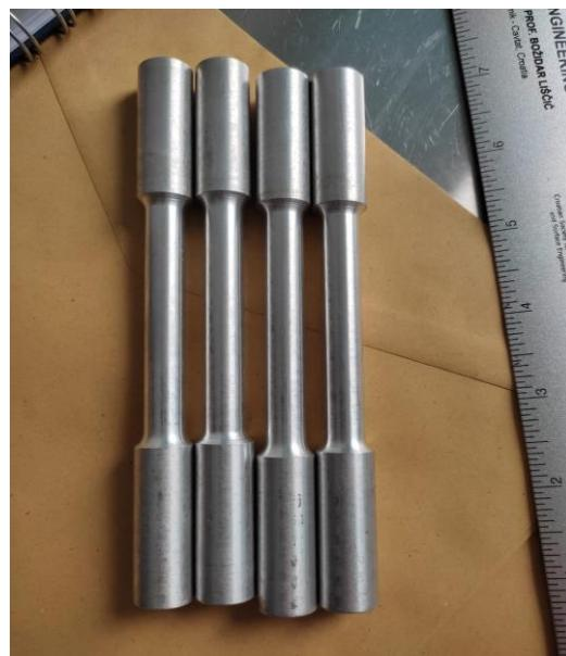
Slika 17. Epruvete za statičko vlačno ispitivanje
