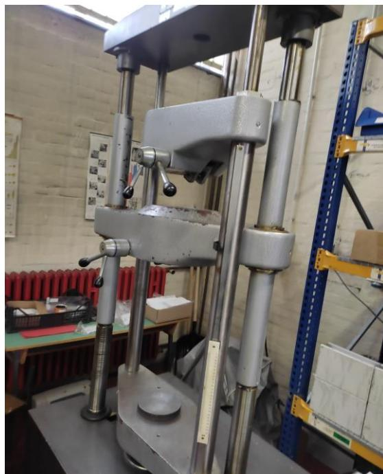
Slika 19. Hidraulička kidalica WEB WPM
