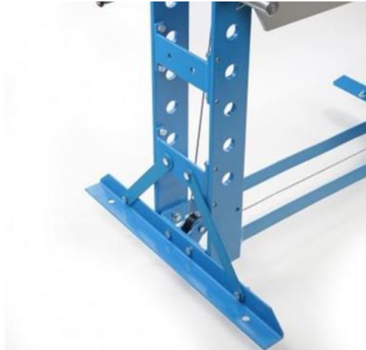
Slika 6. Rješenje stabilnosti hidraulične preše
