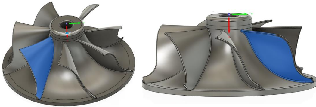
Slika 62 Označene površine u operacijama „Pencil vanjska obrada“ i „Pencil unutarnja obrada“
