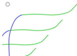
Slika 25 Uvećani detalj ulaza alata u zahvat
