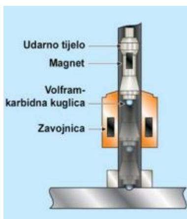
Slika 6. Dijelovi udarnog tijeka kod TIV metode [4]
