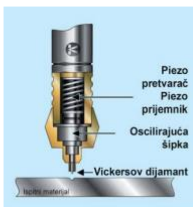
Slika 4. Sonda UCI prijenosnog tvrdomjera [4]
