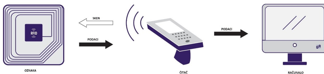
Slika 21. Princip rada RFID sustava [19]
