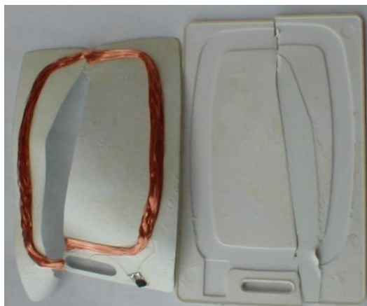
Slika 3. Pasivna beskontaktna kartica, preuzeto sa [3]
