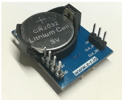
Slika 7. RTC modul PCF85063A
