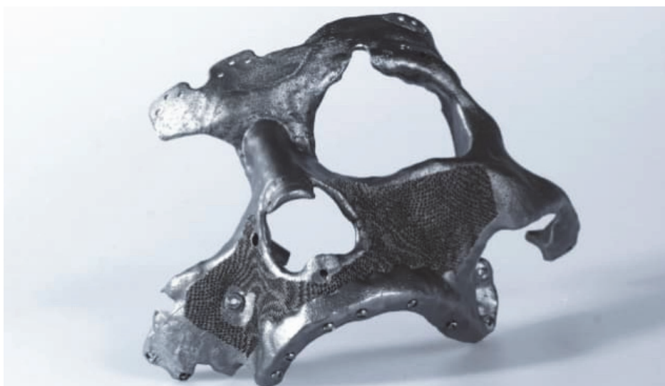
Slika 14. Topološki optimirani implantat lubanje [10]
