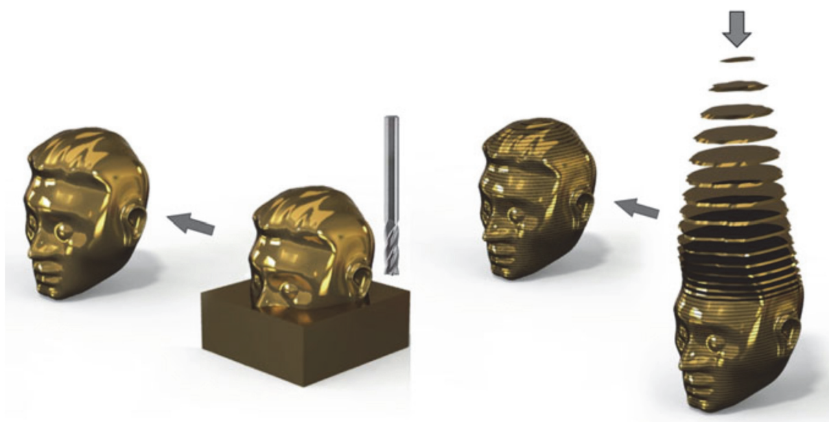
Slika 1. Prikaz razlike između obrade odvajanjem čestica i aditivne proizvodnje [2]
