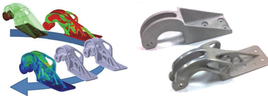
Slika 28. Topološki optimirani nosači poklopca motora zrakoplova [24]
