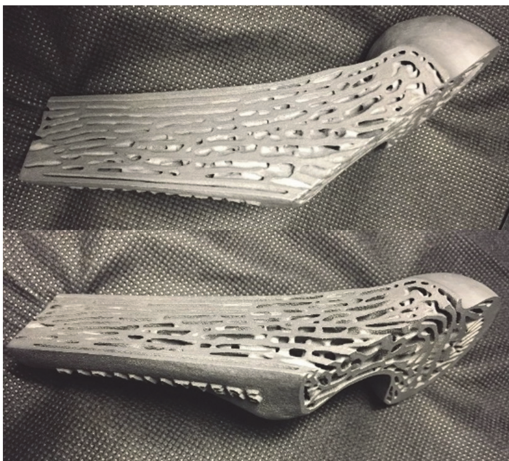
Slika 16 . Optimirani koštani implantat proizveden s pomoću aditivnih tehnologija [11]
