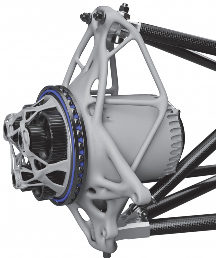
Slika 18. Topološki optimirana glavčina kotača FS bolida [17]
