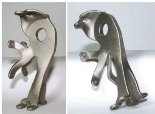
Slika 27. Topološki optimirani i proizvedeni nosač [25]
