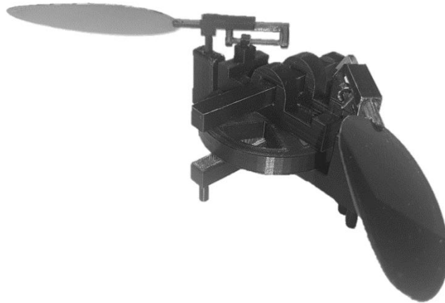
Slika 41. Izrađeni model mehanizma pokretnog krila I
