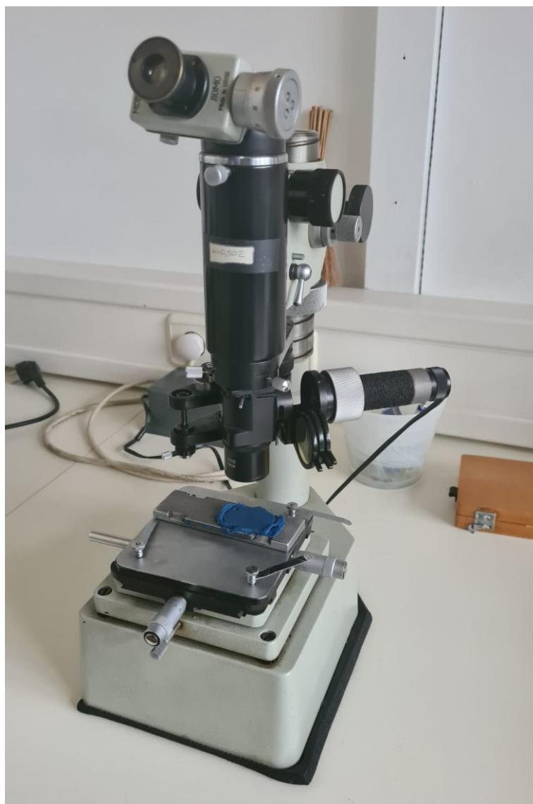
Slika 27. Mikrotvrdomjer PMT-3
