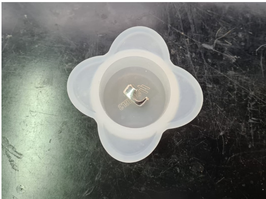
Slika 17. Uzorak ortopedske pločice u kalupu prije zalijevanja
