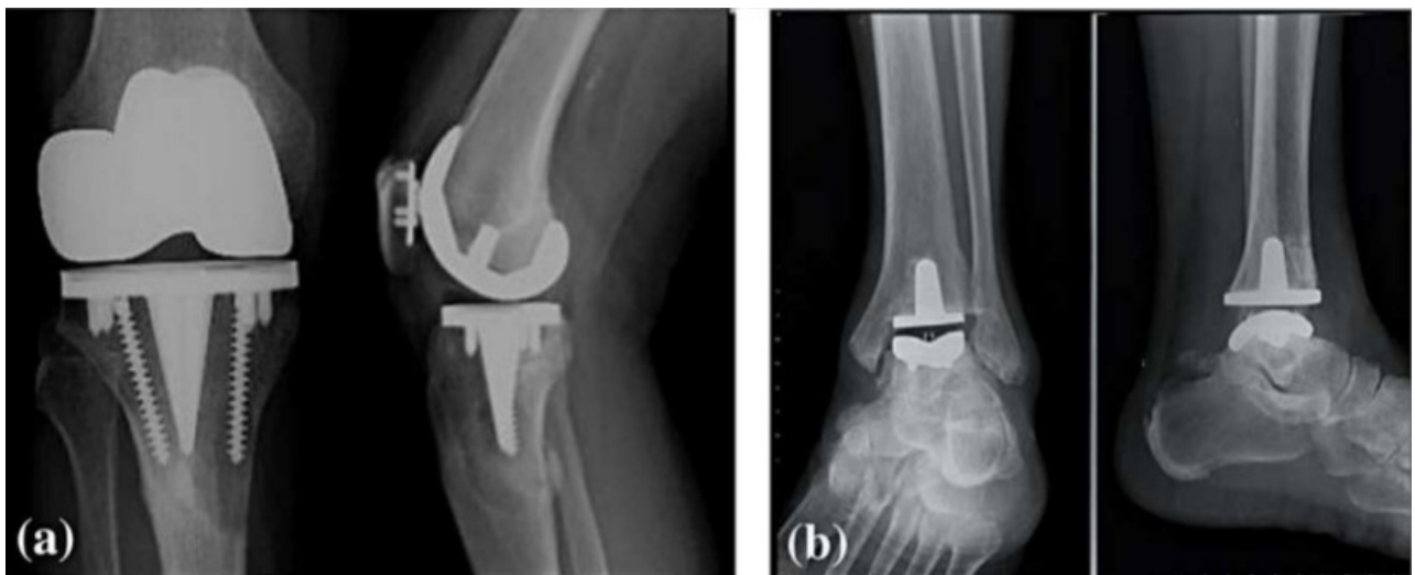
Slika 11. Primjeri primjene čelika X2CrNiMo17-2-2 za implantate u koljenu (a) i gležnju (b) [14]
