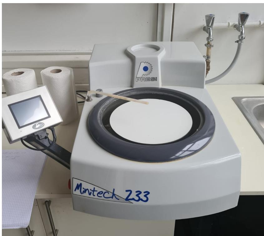
Slika 18. Uredaj za brušenje uzorka Presi Minitech 233
