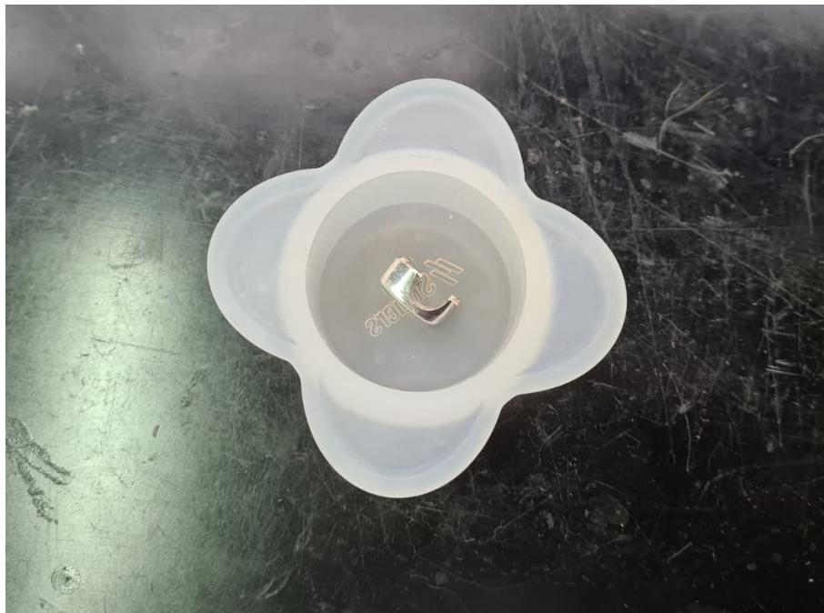
Slika 17. Uzorak ortopedske pločice u kalupu prije zalijevanja
