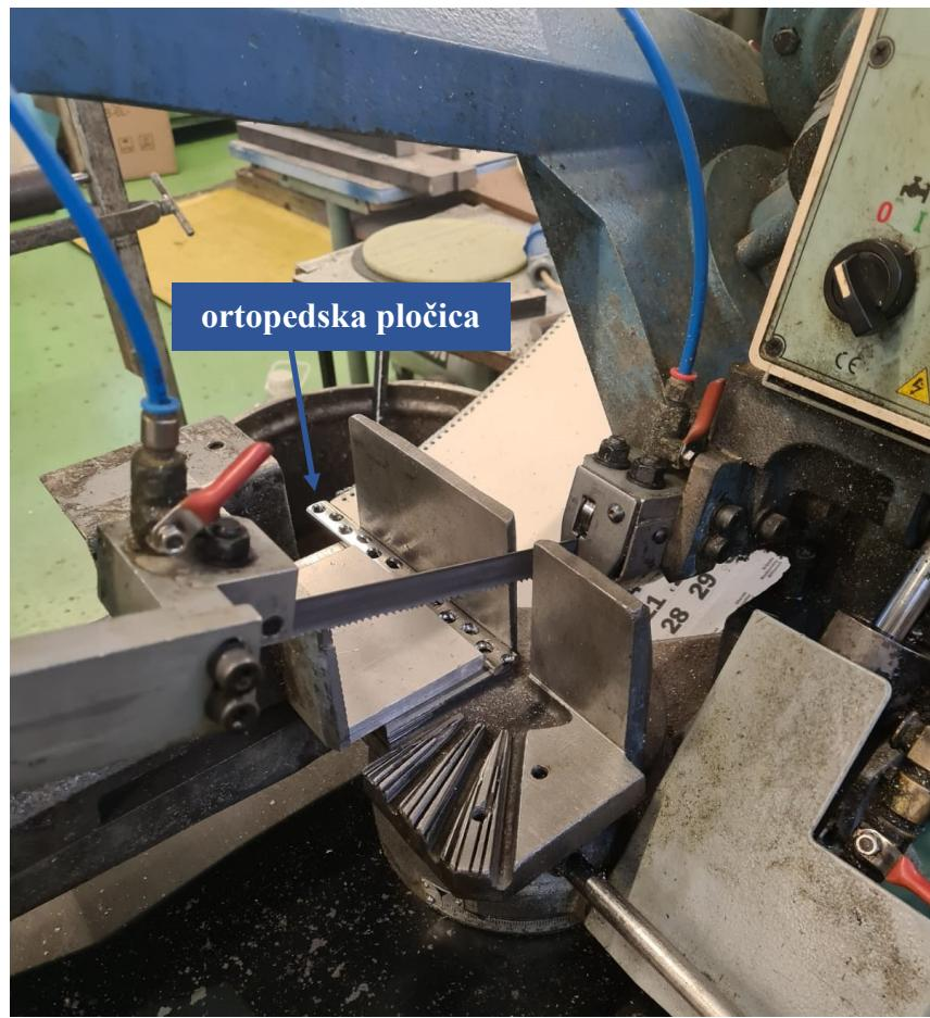
**Slika 15.** Izrezivanje uzorka na tračnoj pili
