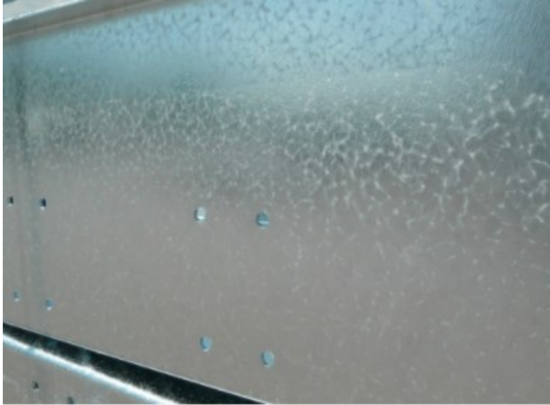
Slika 8 Specifični izgled površine uslijed Sandelin efekta [7]
