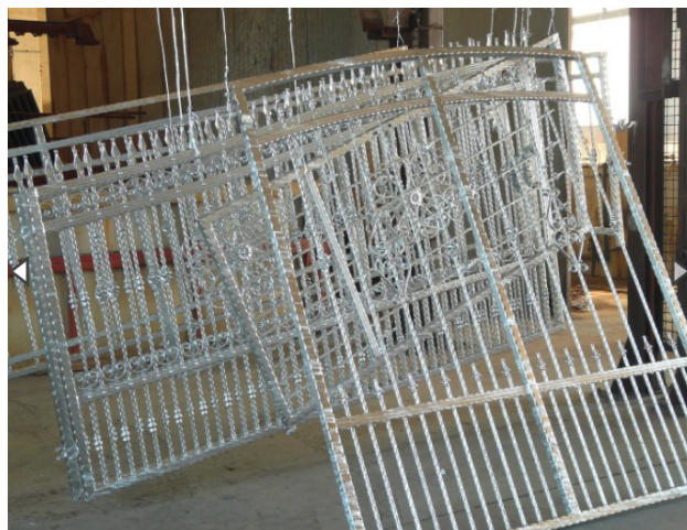
Slika 9 Primjer pocinčane ograde [7]
