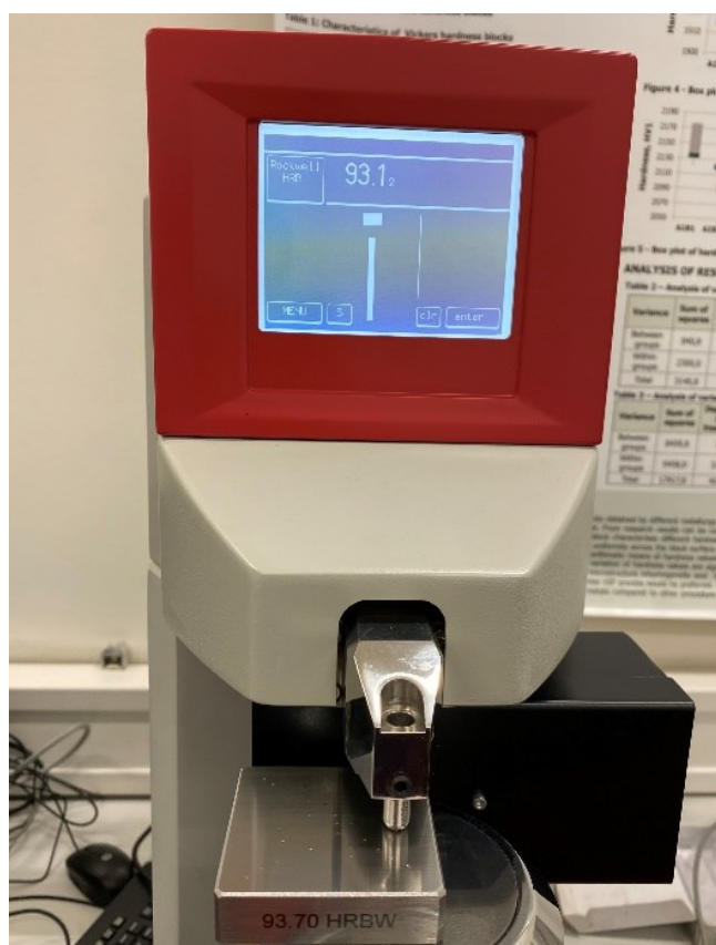
Slika 15. Proces mjerenja tvrdoće
