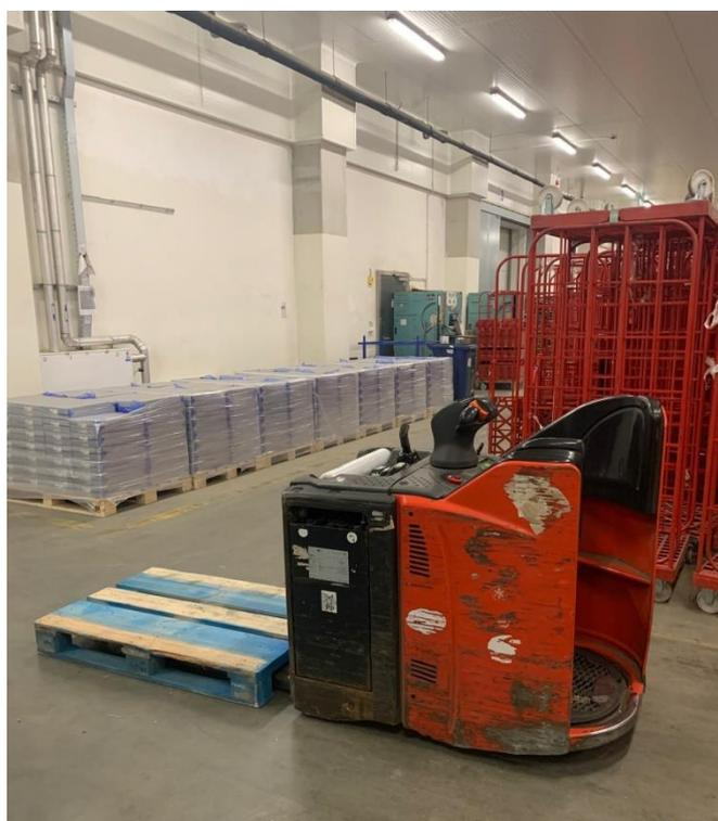
**Slika 20. Električni paletni niskopodizni viličar**
