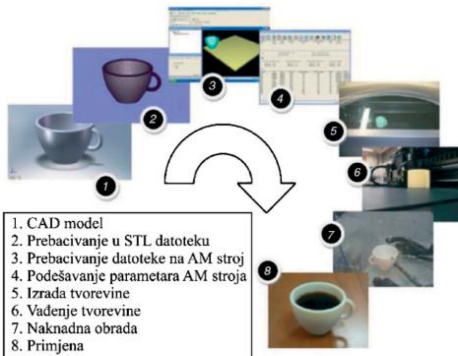
Slika 5. Faze 3D proizvodnje [5]
