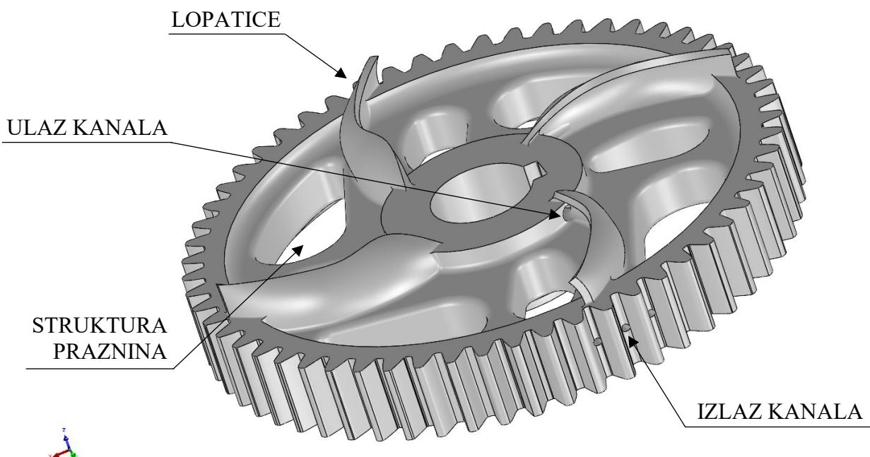
Slika 18. CAD model zupčanika prema odabranom konceptu
