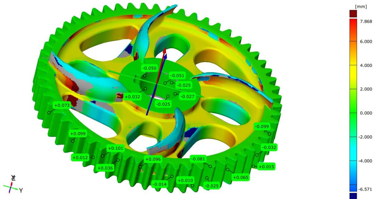
Slika 29. Preklopljeni modeli početnog i izrađenog polimernog zupčanika
