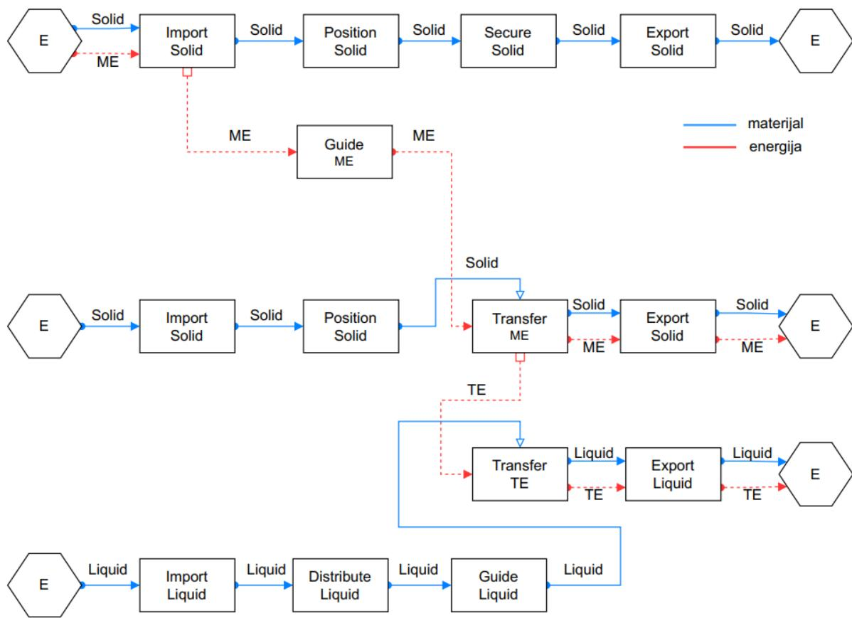
**Slika 9. Funkcijska analiza - hlađenje tekućinom za hlađenje**
