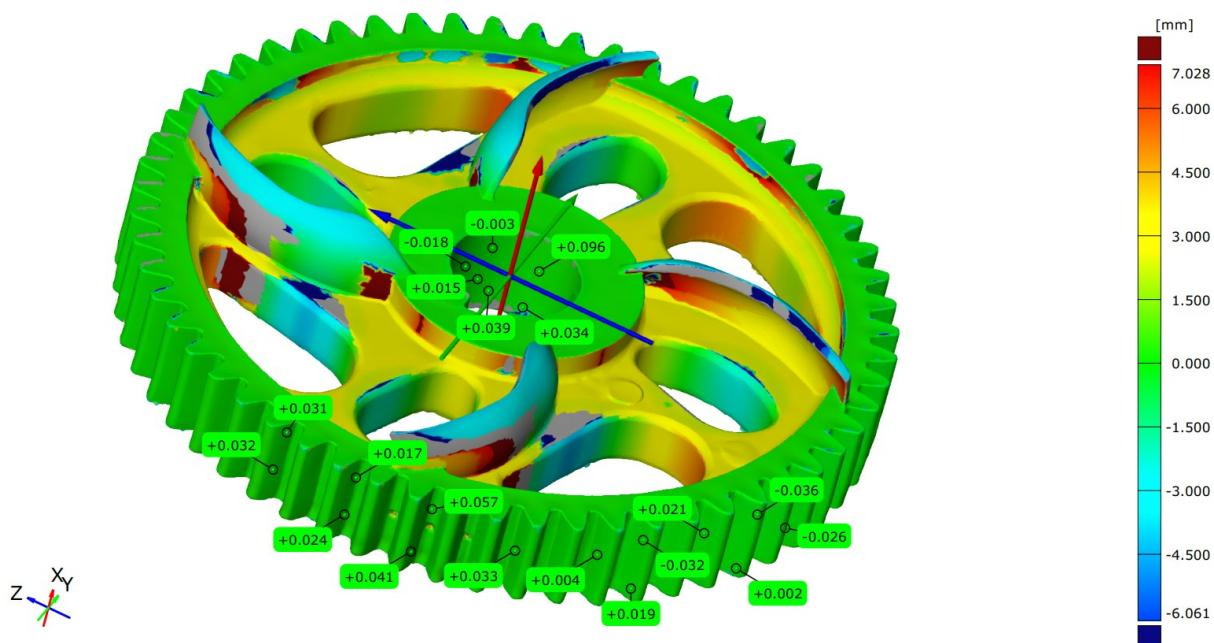
Slika 28. Preklopljeni modeli početnog i izrađenog metalnog zupčanika
