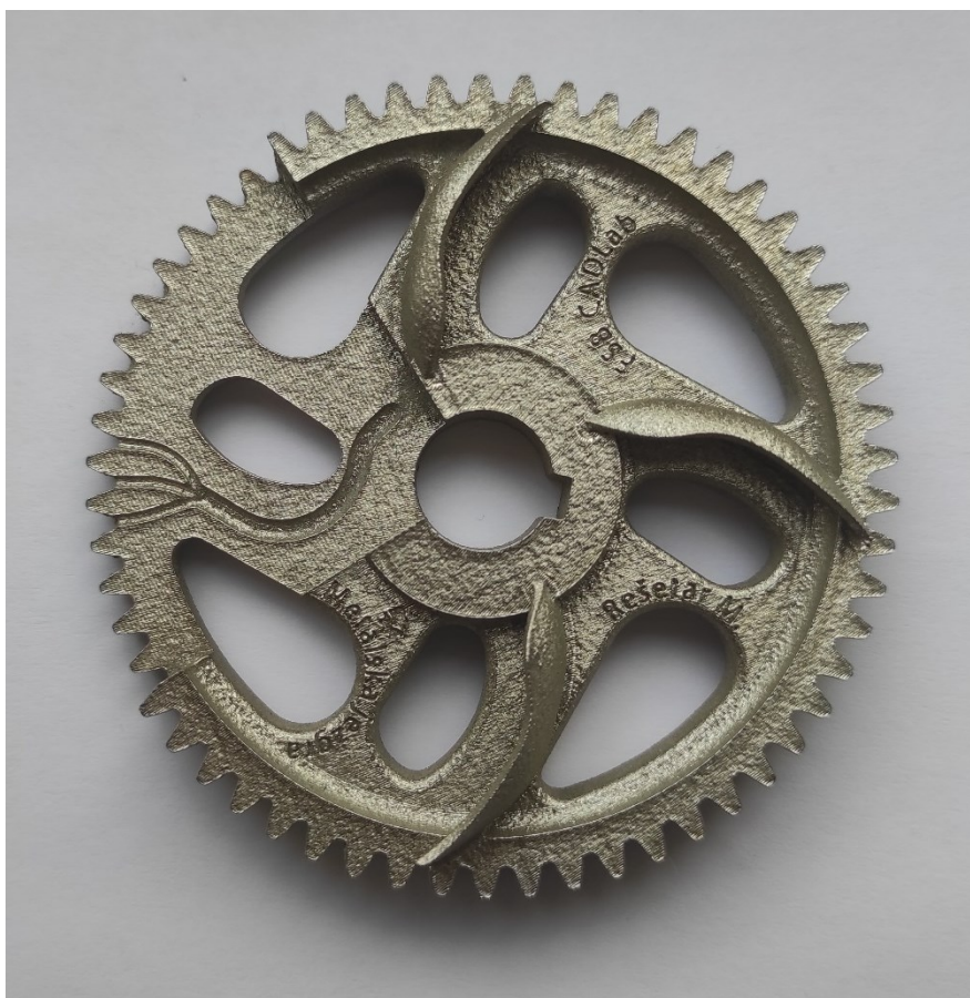
Slika 25. Izrađeni metalni zupčanik s presjekom
