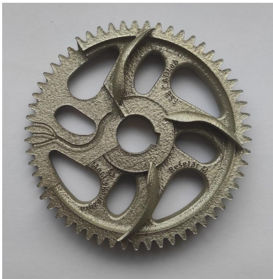
Slika 25. Izrađeni metalni zupčanik s presjekom
