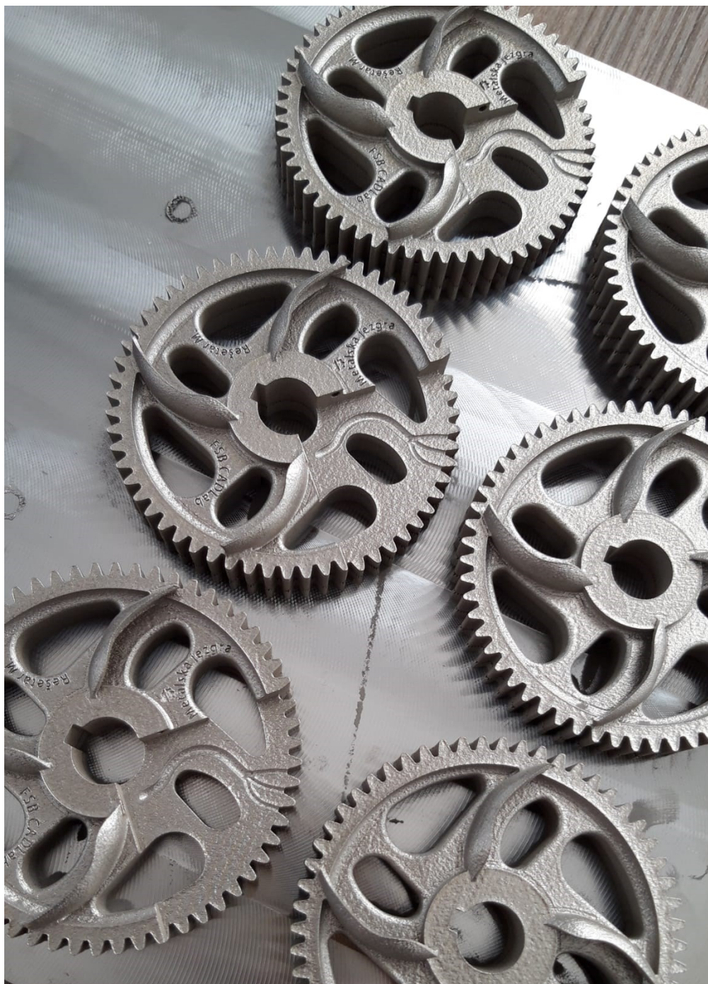
Slika 22. Izrađeni modeli zupčanika
