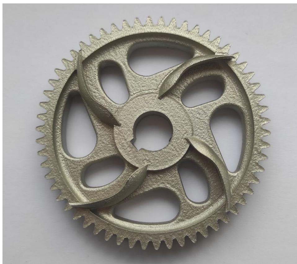
Slika 24. Izrađeni metalni zupčanik
