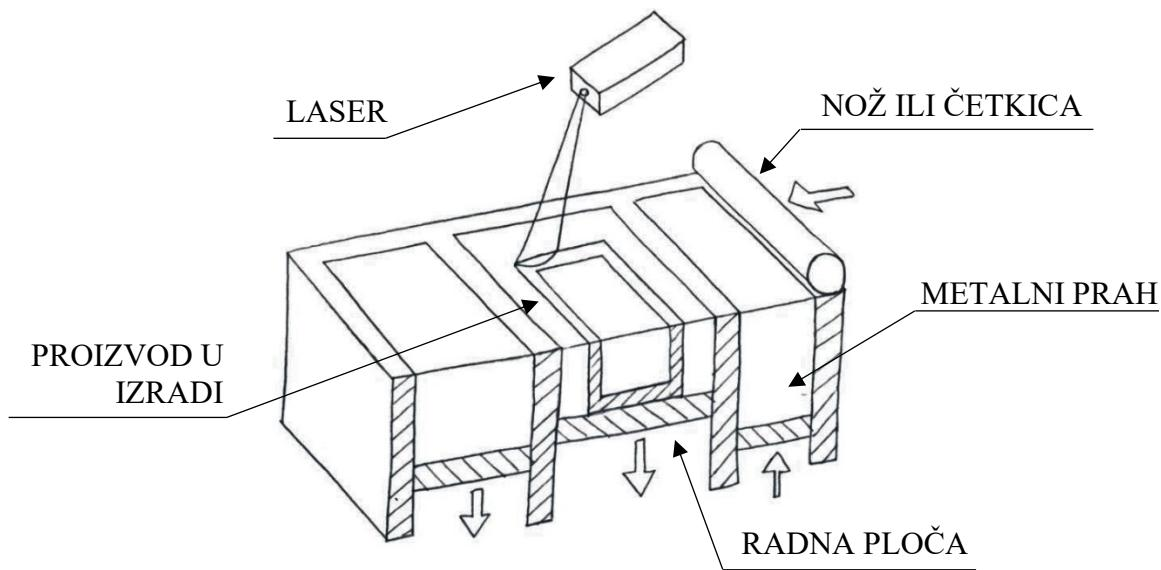
**Slika 2. Skica uređaja za DMLS postupak aditivne proizvodnje**
