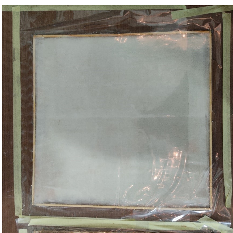
Slika 4.11 Završetak laminiranja i priprema sušenja
