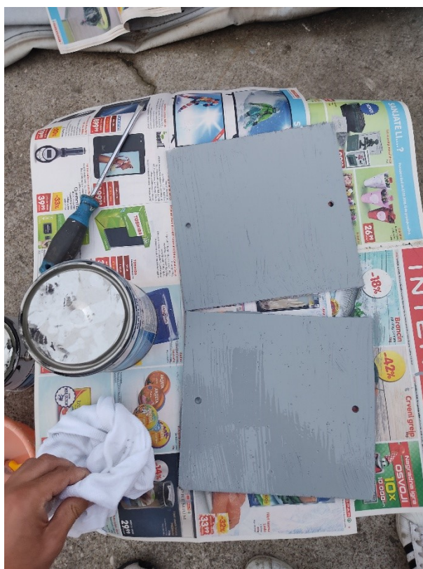
Slika 5.22 Test ploče nakon nanošenja temeljnog premaza
