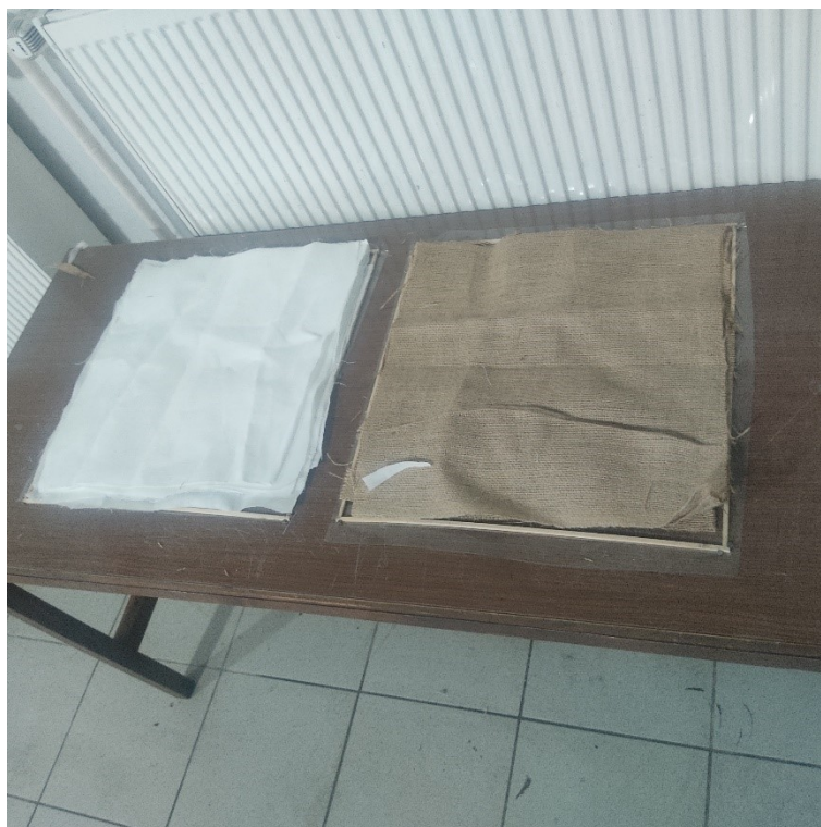
Slika 4.10 Priprema vlakana za laminiranje
