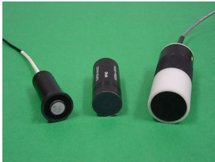
Slika 13: Niskofrekventne površinske sonde [4]
