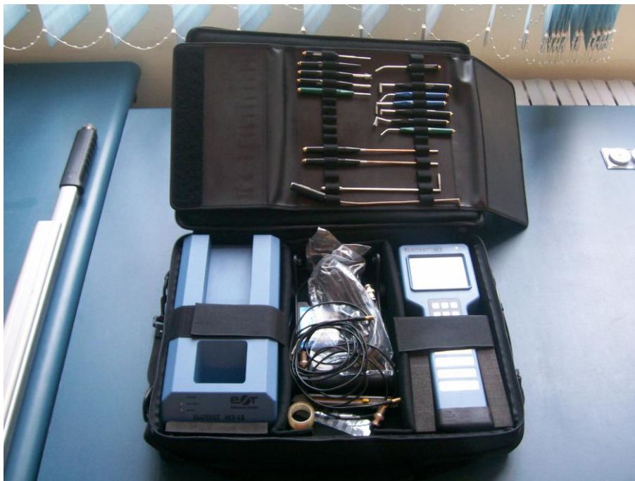
Slika 7: Tipičan komplet za ispitivanje vrtložnim strujama
