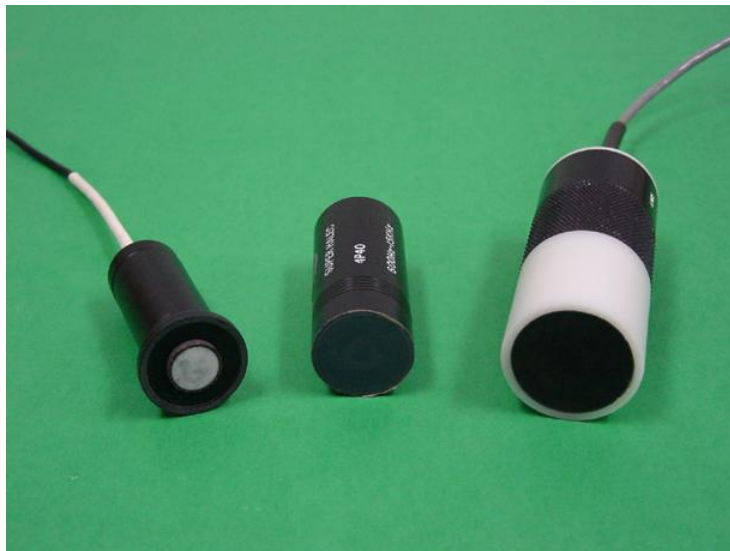
Slika 13: Niskofrekventne površinske sonde [4]
