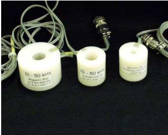
Slika 17: Sonde za vanjske promjere [2]
