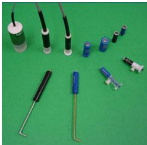
Slika 8: Nekoliko apsolutnih sondi [4]
