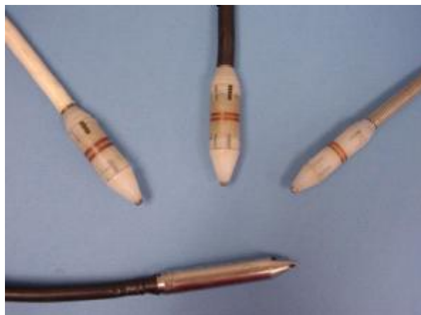
Slika 16: Sonde za unutarnje promjere [4]
