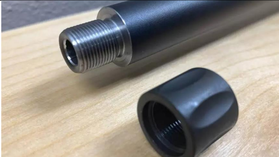
Slika 17. Uvećan prikaz navoja na koji se zavrne moderator [8]
