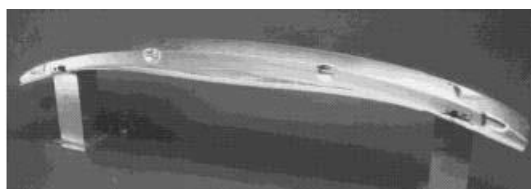
Slika 12. Branik vozila od metalne pjene [2]
