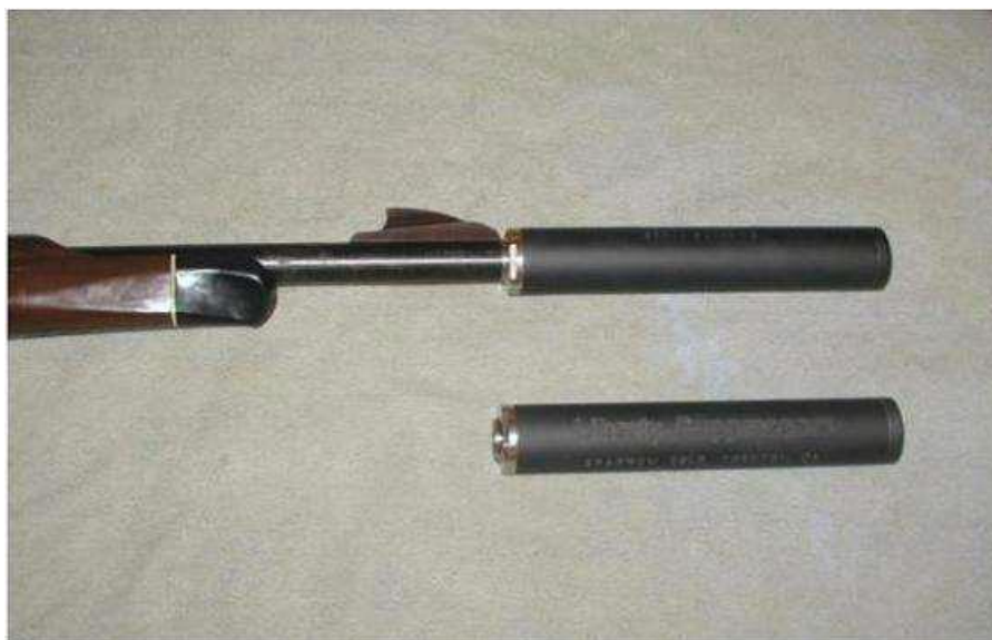
Slika 16. Moderator zvuka koji se montira na kraj cijevi [7]
