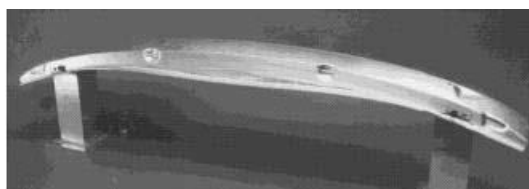
Slika 12. Branik vozila od metalne pjene [2]
