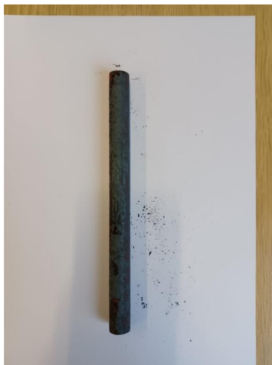
Slika 13. Žareni uzorak nakon ohlađivanja
