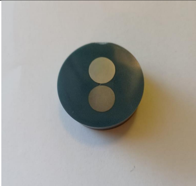
Slika 18. Izrezani uzorci u polimernoj masi
