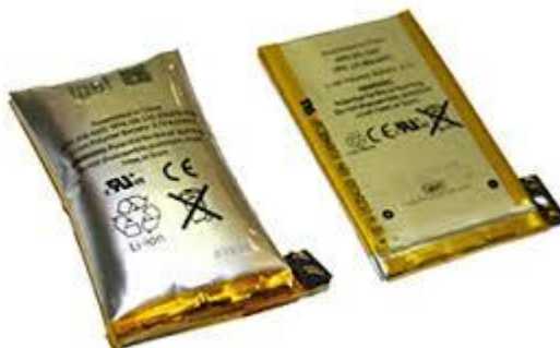
Slika 18. Prikaz bubrenja pouch ćelije [19]
