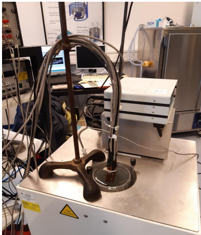
Slika 9. Slaganje termometara u kupku
