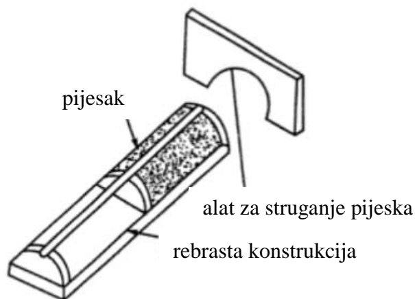
Slika 15. Skeletni model jednostavnijih dijelova [7]
