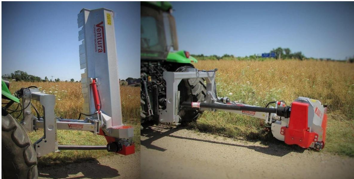
**Slika 16.** Konstrukcija prihvata u 3 točke na malčeru tvrtke Ventura [13]
