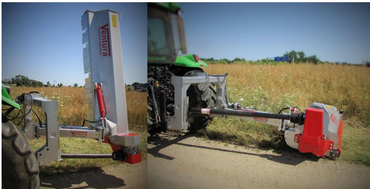
Slika 16. Konstrukcija prihvata u 3 točke na malčeru tvrtke Ventura [13]
