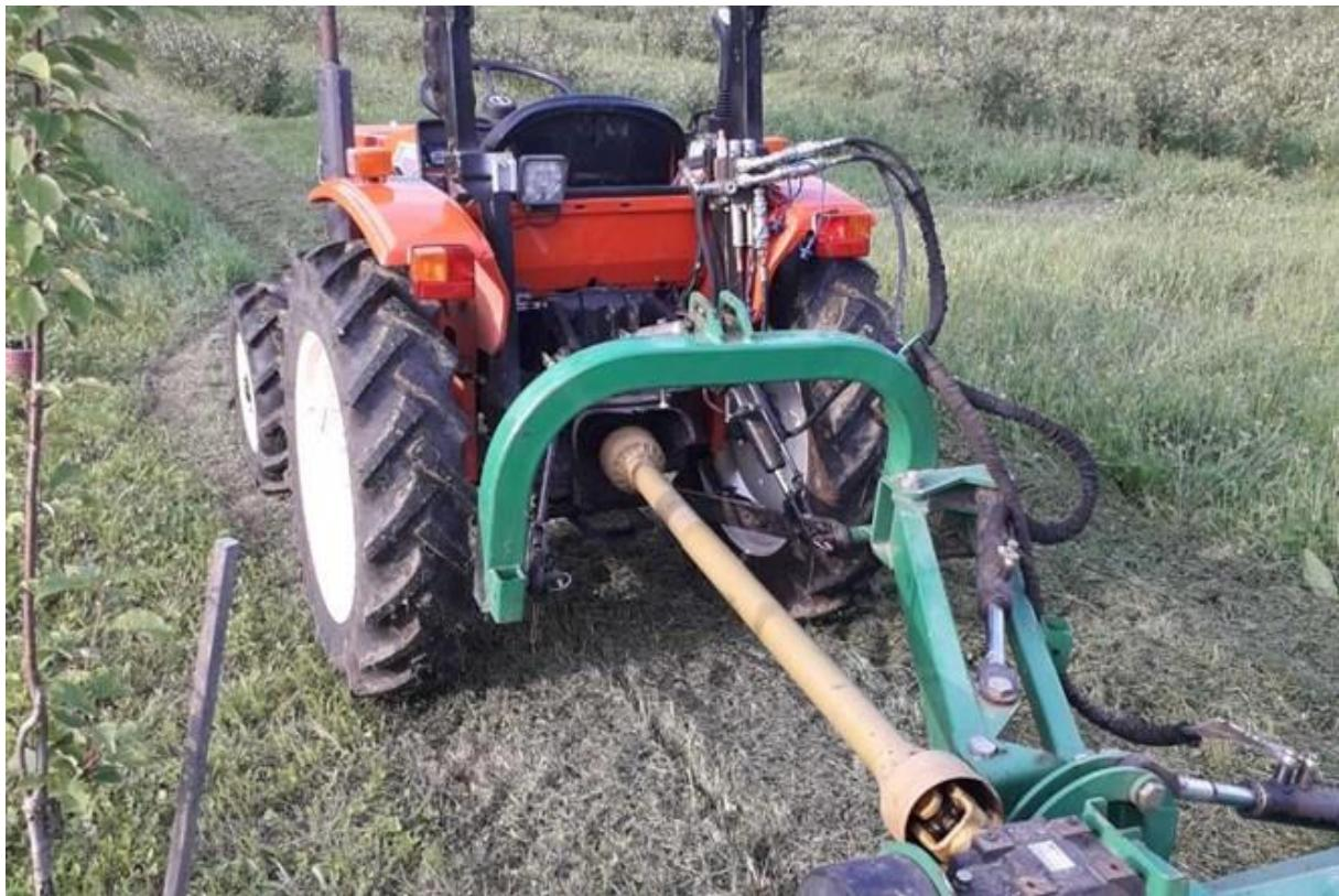
Slika 7. Kardansko vratilo spojeno na traktor (žuto) [8]
