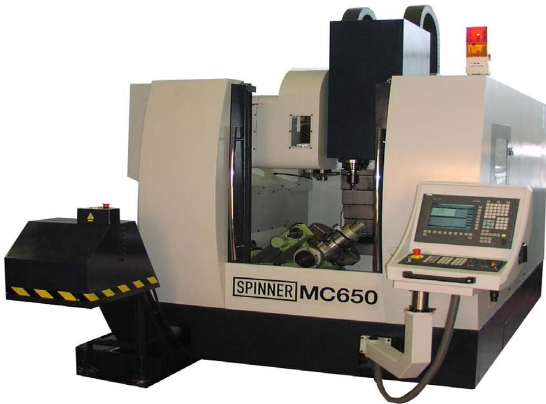
Slika 10. Vertikalni glodači obradni centar [5].
