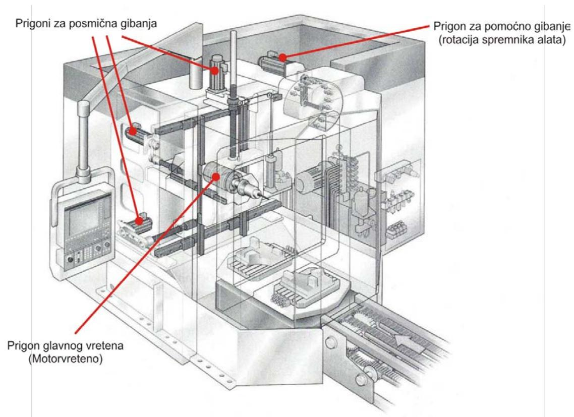
Slika 13. Prigoni na glodačem obradnom centru [7].
