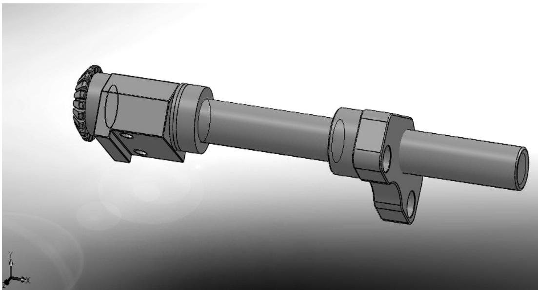
Slika 35. CAD model trapeznog navojnog vretena s maticom.
