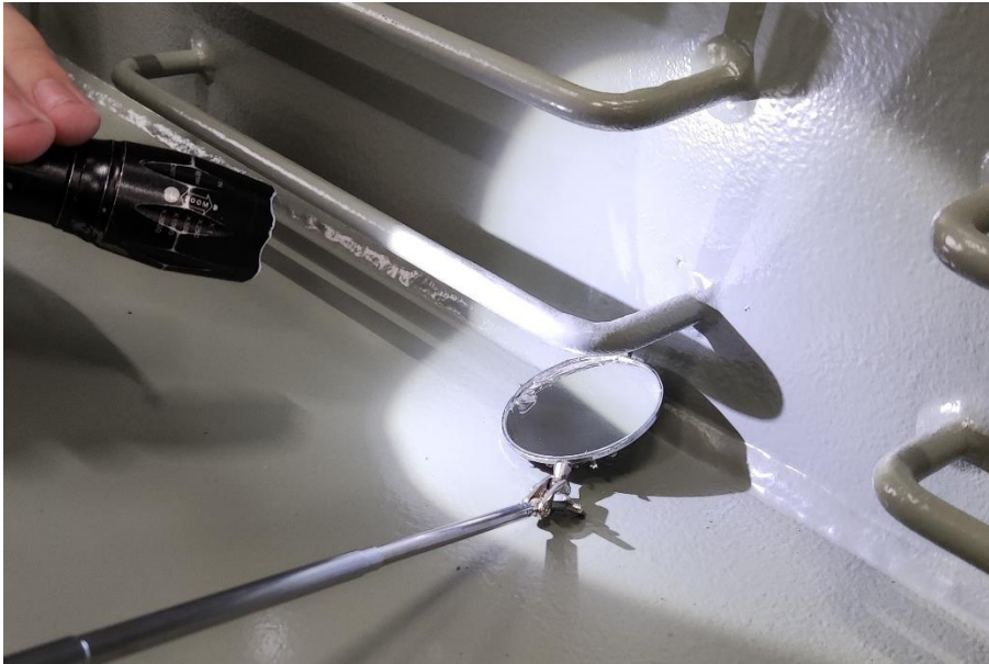
Slika 27. Kontrola kvalitete nanošenja premaza na teško dostupnom mjestu
