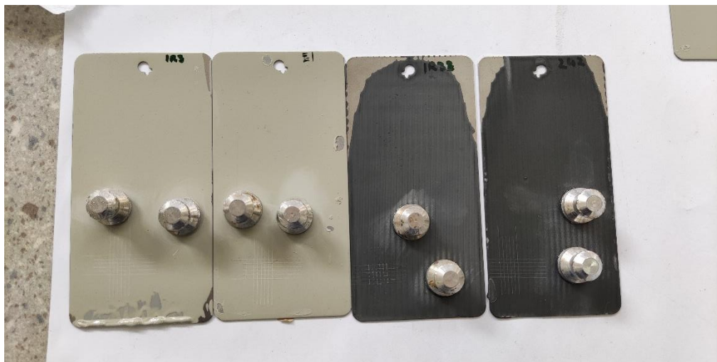
Slika 39. Čunjići zalijepljeni na ispitne uzorke
