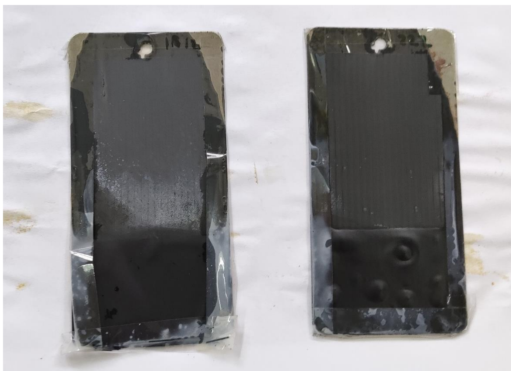
Slika 67. Uzorci nakon 48 sati izlaganja klorovodičnoj kiselinu - Hempadur Avantguard 770
