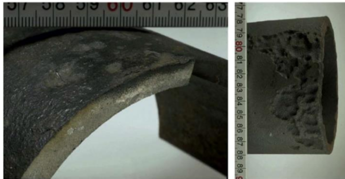
Slika 6. Selektivna korozija – grafitizacija [5]
