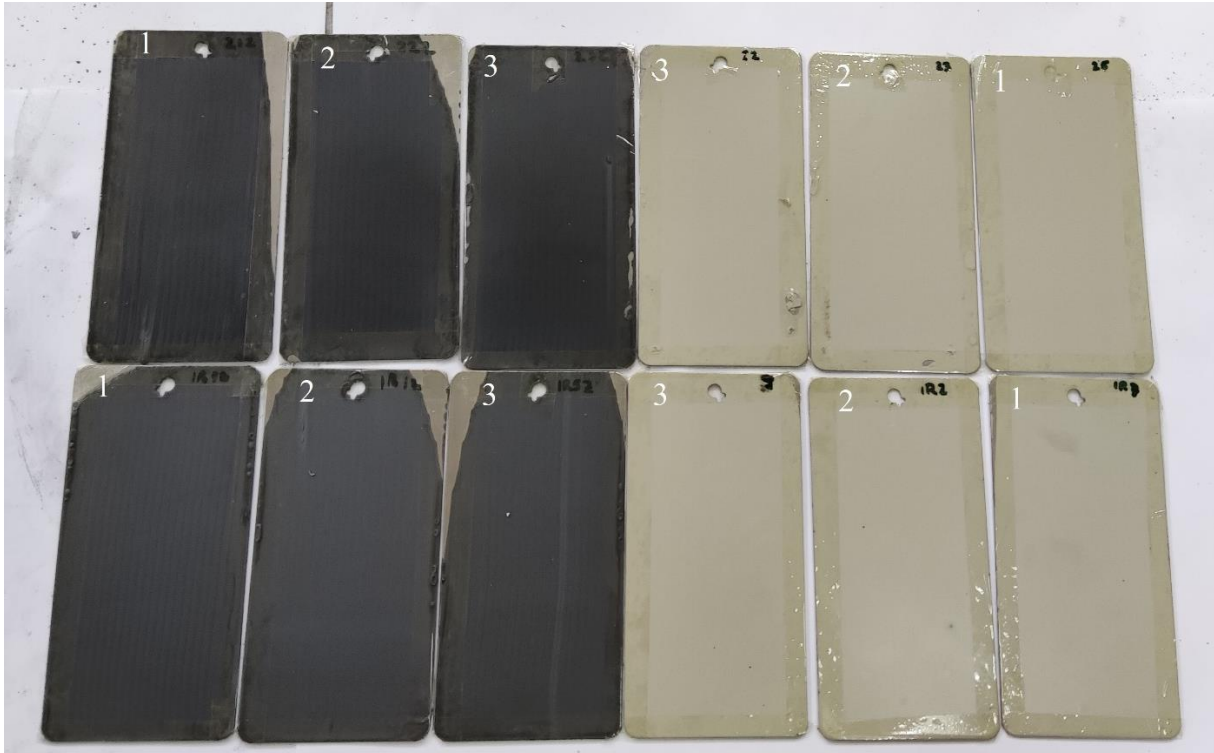
Slika 62. Uzorci pripremljeni za uranjanje u kiseline
