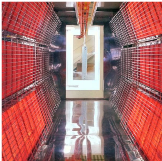
Slika 18. Komora za katalitičko IC sušenje premaza [23]
