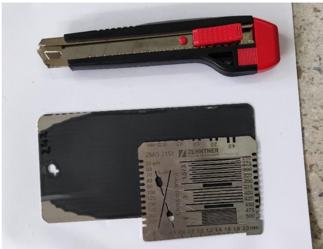
Slika 41. Izgled etalona za urezivanje cross-cut metodom
