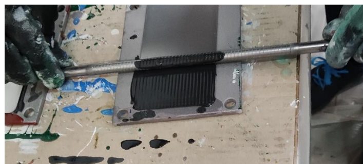
Slika 33. Nanošenje premaza spiralnim aplikatorom
