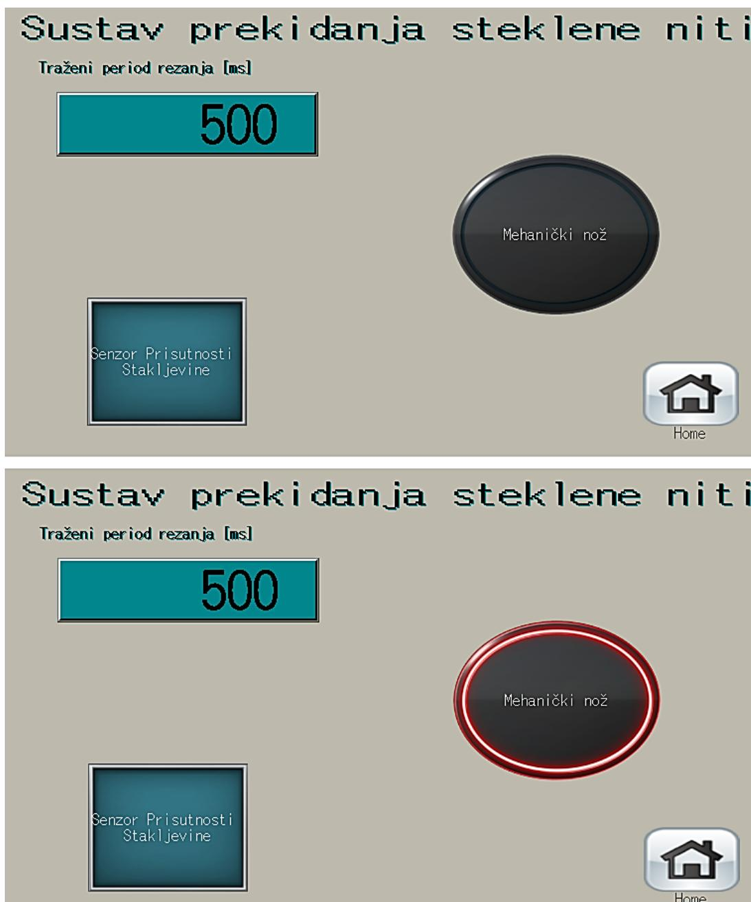
Slika 49. Grafičko sučelje sustava za prekidanje staklene niti
