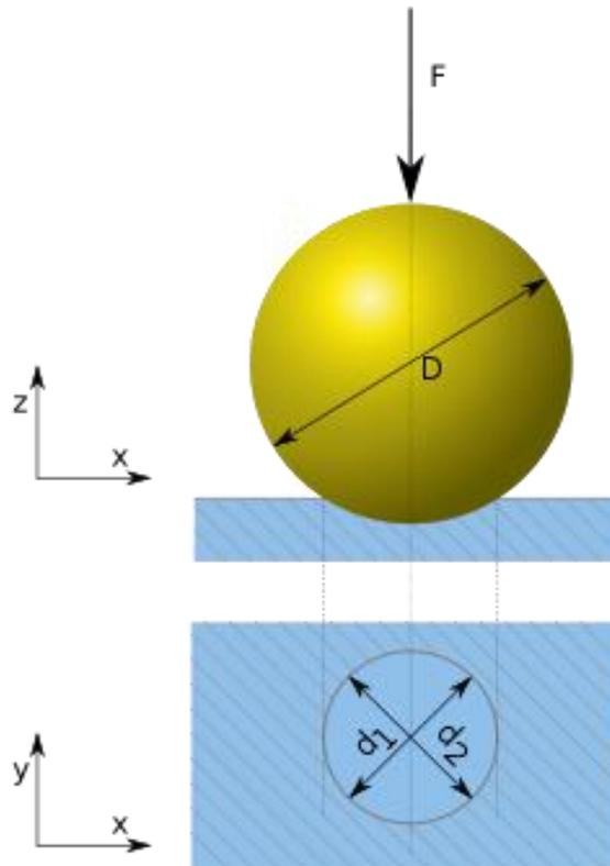
Slika 10 Shematski prikaz ispitivanja tvrdoće Brinellovom metodom [19]
