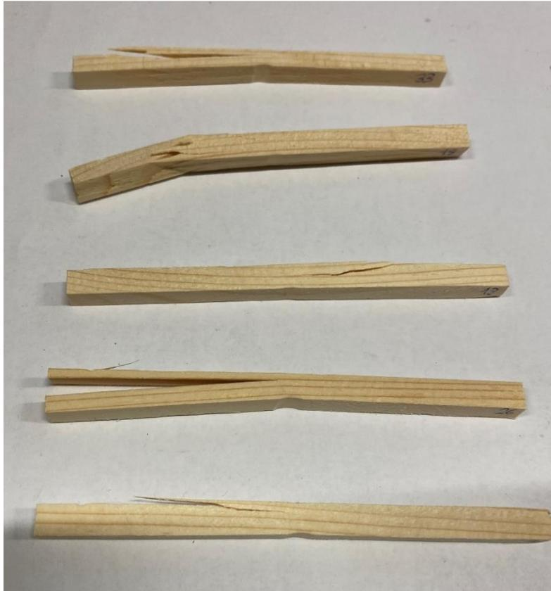
**Slika 25** Karakterističan izgled lomova na ispitnim uzorcima L90 (90°)
