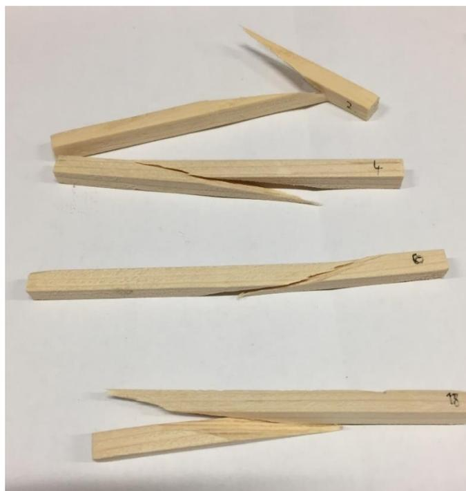
**Slika 23** Karakterističan izgled lomova na ispitnim uzorcima L45 (45°)
