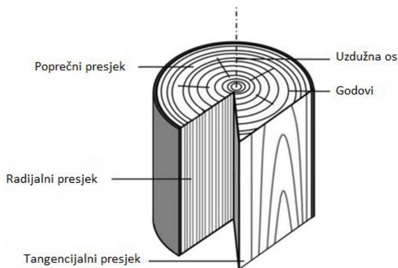
Slika 4 Poprečni, tangencijalni i radijalni presjeci debla [10]
