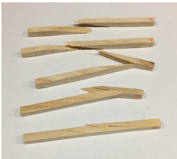
Slika 21 Karakterističan izgled lomova na ispitnim uzorcima L0 (0°)
