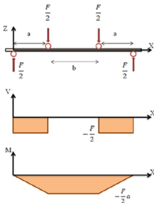
Slika 12 Metoda ispitivanja savojne čvrstoće u četiri točke [20]
