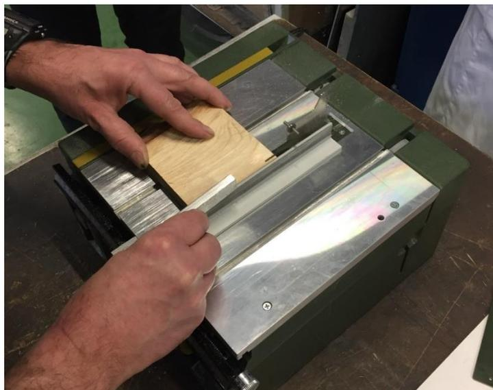
**Slika 16 Izrezivanje epruveta**
