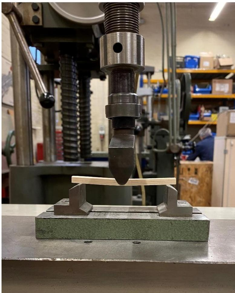
**Slika 19 Savijanje ispitnog uzorka na kidalici**
