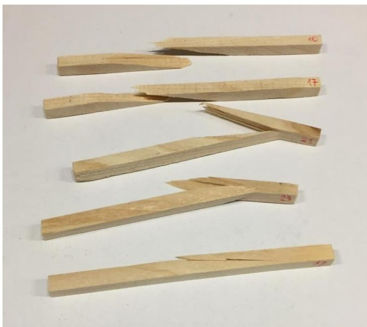
Slika 21 Karakterističan izgled lomova na ispitnim uzorcima L0 (0°)
