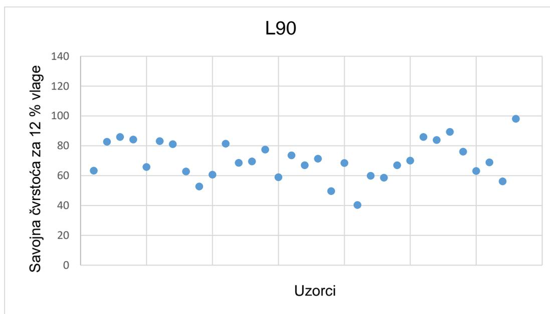
**Slika 24** Vrijednosti savojne čvrstoće uzoraka L90 za 12 % vlage
