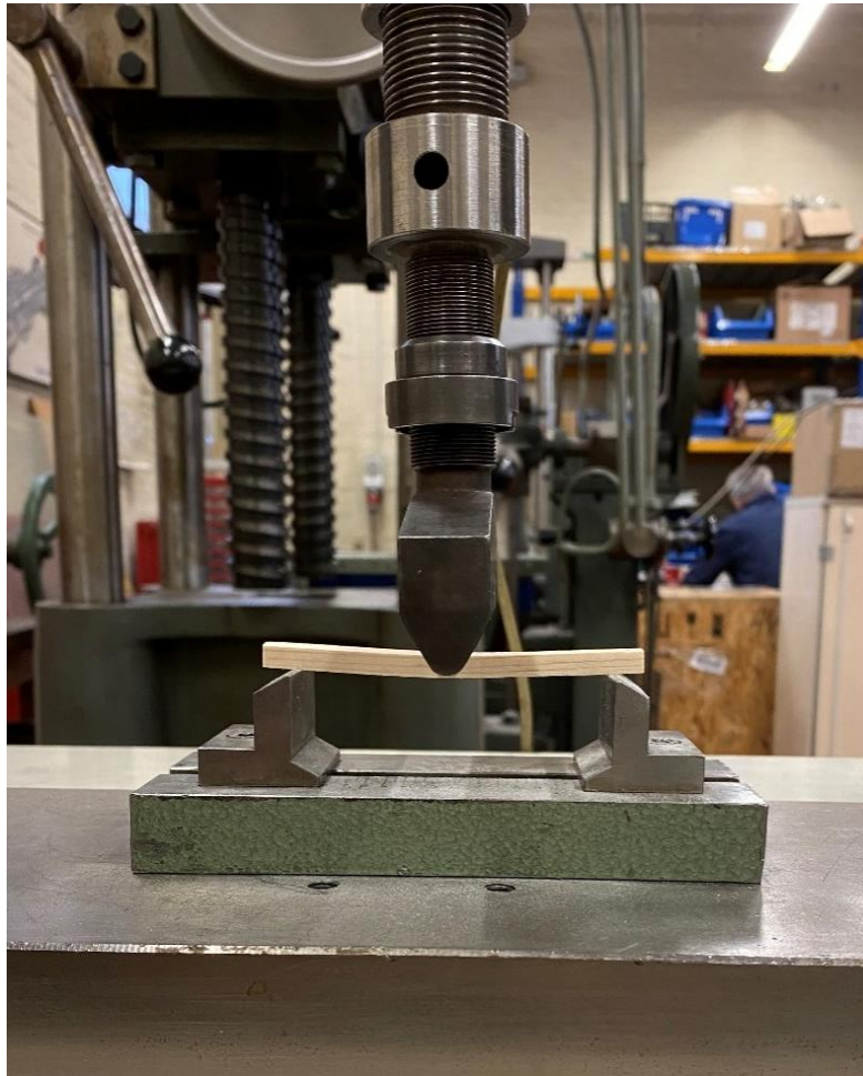
Slika 19 Savijanje ispitnog uzorka na kidalici
