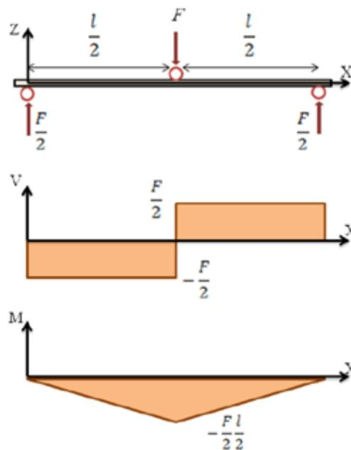
Slika 11 Metoda ispitivanja savojne čvrstoće u tri točke [20]
