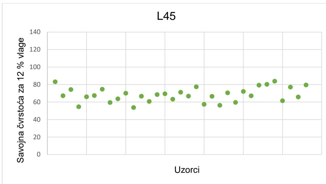
**Slika 22** Vrijednosti savojne čvrstoće uzoraka L45 za 12 % vlage
