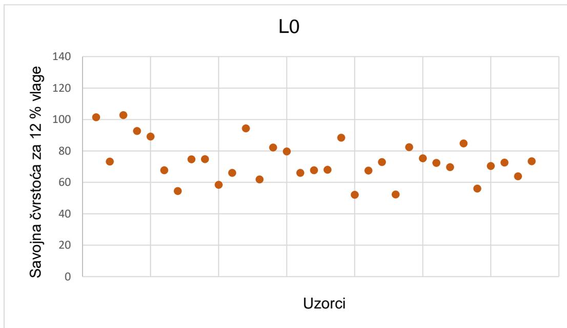
Slika 20 Vrijednosti savojne čvrstoće uzoraka L0 za 12 % vlage
