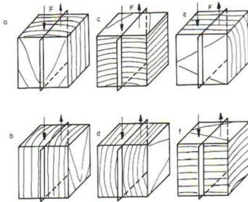
Slika 14 Shematski prikaz mogućih smičnih naprezanja [22]
