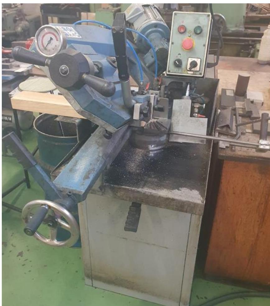
**Slika 4.2 Tračna pila**
