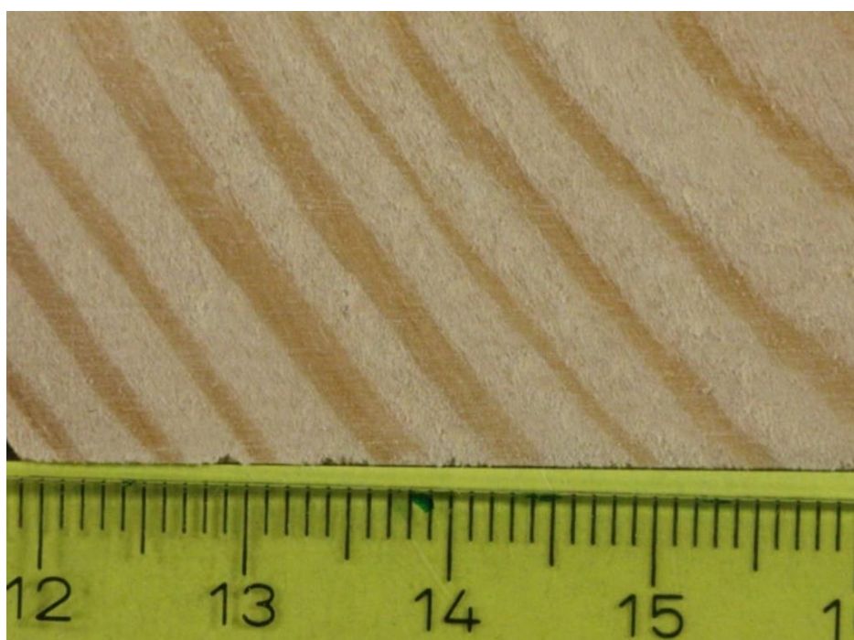
Slika 4.8 Uzorak s oznakom 60°R
