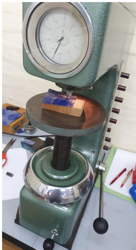
Slika 4.11 Tvrdomjer VEB WPM HP 250
