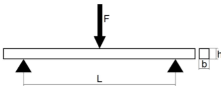
Slika 3.2 Određivanje savojnog modula elastičnosti metodom u tri točke [1]
