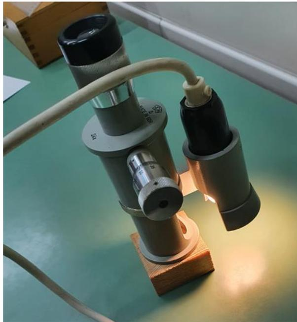
Slika 4.12 Uređaj za precizno mjerenje promjera otiska
