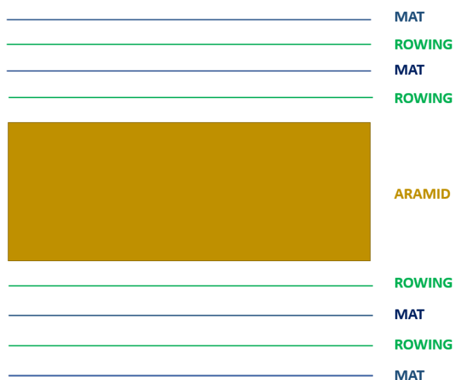
Slika 19. Struktura kompozitne ploče
