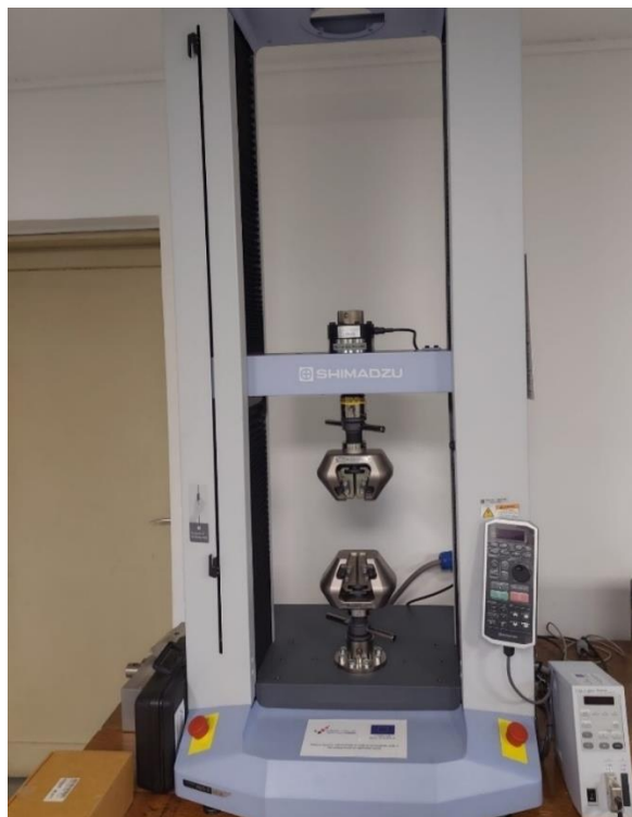
Slika 35. Shimadzu uređaj korišten za vlačno ispitivanje
