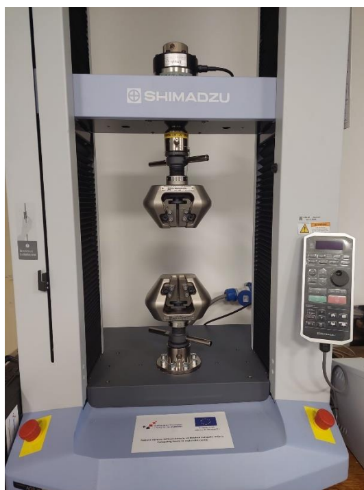
Slika 33. Shimadzu uređaj korišten za savojno ispitivanje
