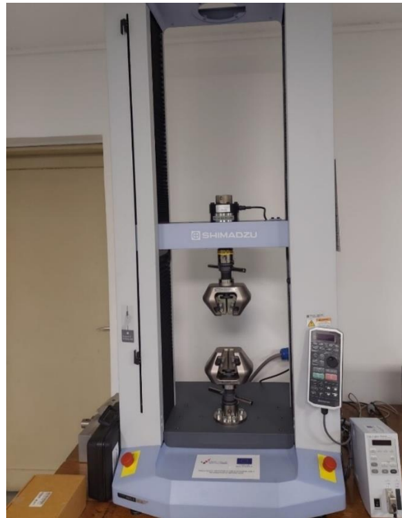
Slika 35. Shimadzu uređaj korišten za vlačno ispitivanje
