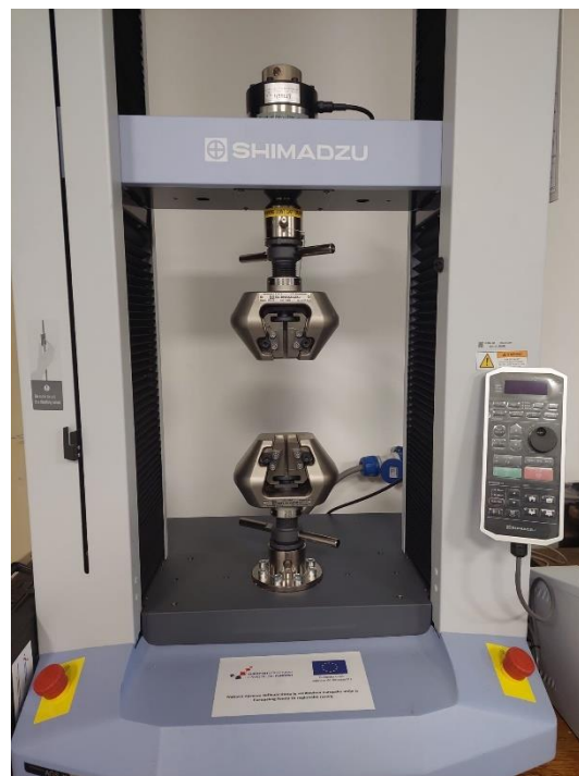
Slika 33. Shimadzu uređaj korišten za savojno ispitivanje
