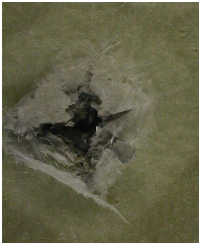
Slika 30. Izlaz metka kalibra ".357" iz kompozitne ploče
