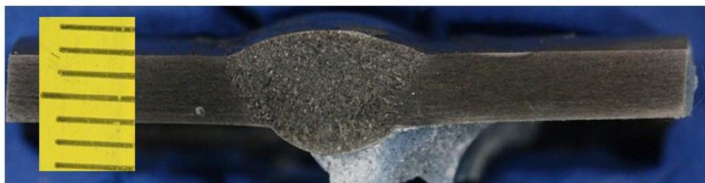
Slika 35. Makrostruktura zavarenog spoja
