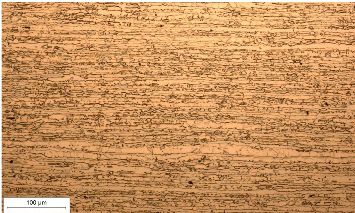
Slika 37. Mikrostruktura osnovnog materijala snimljena pri povećanju  $200\times$
