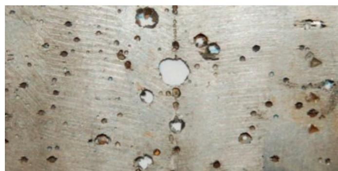
Slika 6. Točkasta korozija čelika [13]
