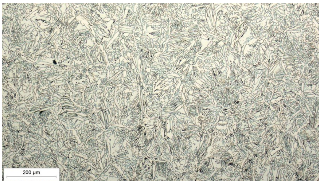
Slika 47. Mikrostruktura metala zavara u sredini zavara, snimljena pri povećanju 100×
