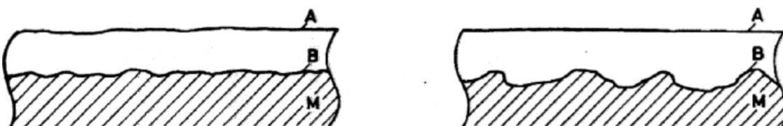
Slika 5. Ravnomjerna (lijevo) i neravnomjerna (desno) opća korozija [12]
