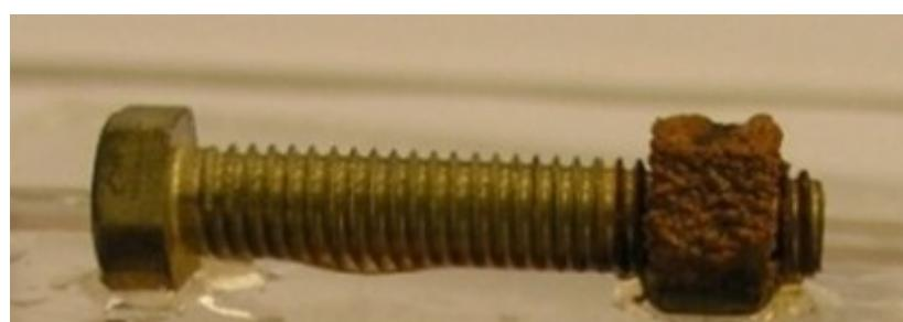
Slika 7. Galvanska korozija mjerdi i čelika [14]
