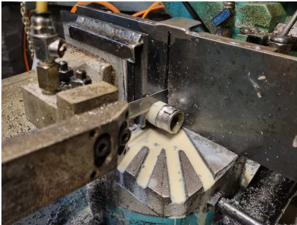
Slika 30. Postupak rezanja cijevi tračnom pilom
