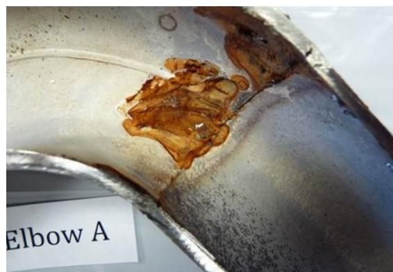
Slika 8. Korozija u procjepu čelika [15]
