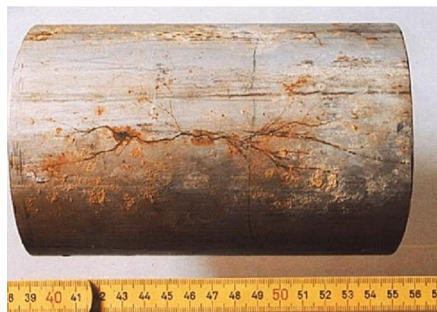
Slika 9. Napetosna korozija čelika [16]
