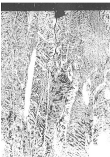
Slika 26. Topla pukotina u metalu zavara zavarenog spoja dupleks čelika [20]
