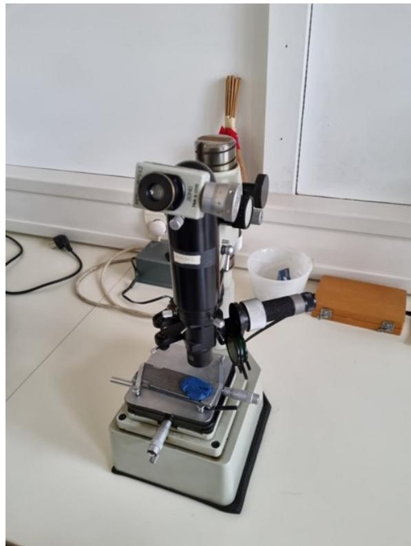
Slika 50. Mikrotvrdomjer, model PMT-3.
