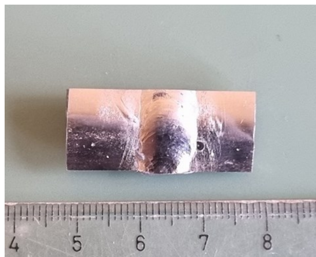
Slika 31. Izrezani uzorak zavarenog spoja cijevi
