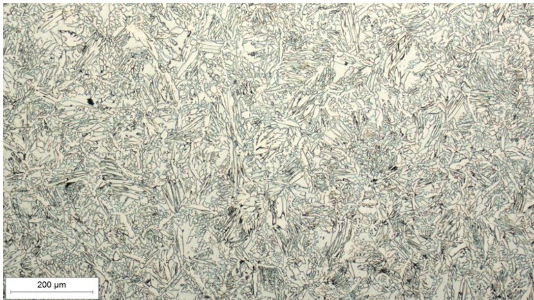
Slika 47. Mikrostruktura metala zavara u sredini zavara, snimljena pri povećanju 100×
