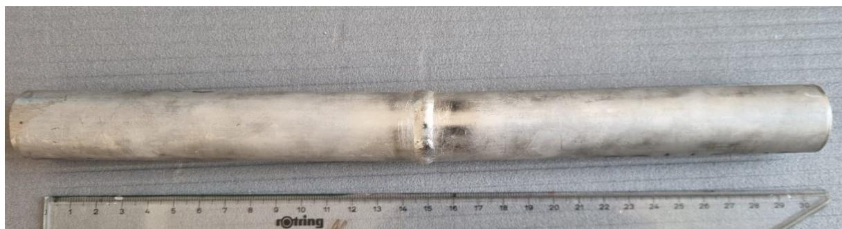
Slika 28. Zavarena cijev čelika X2CrNiMoN 25-7-4
