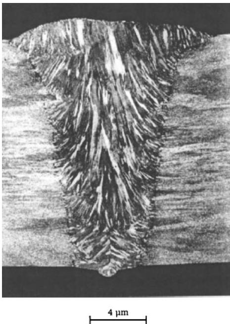
**Slika 25.** Višeprolazni metal zavara dupleks čelika [20]
