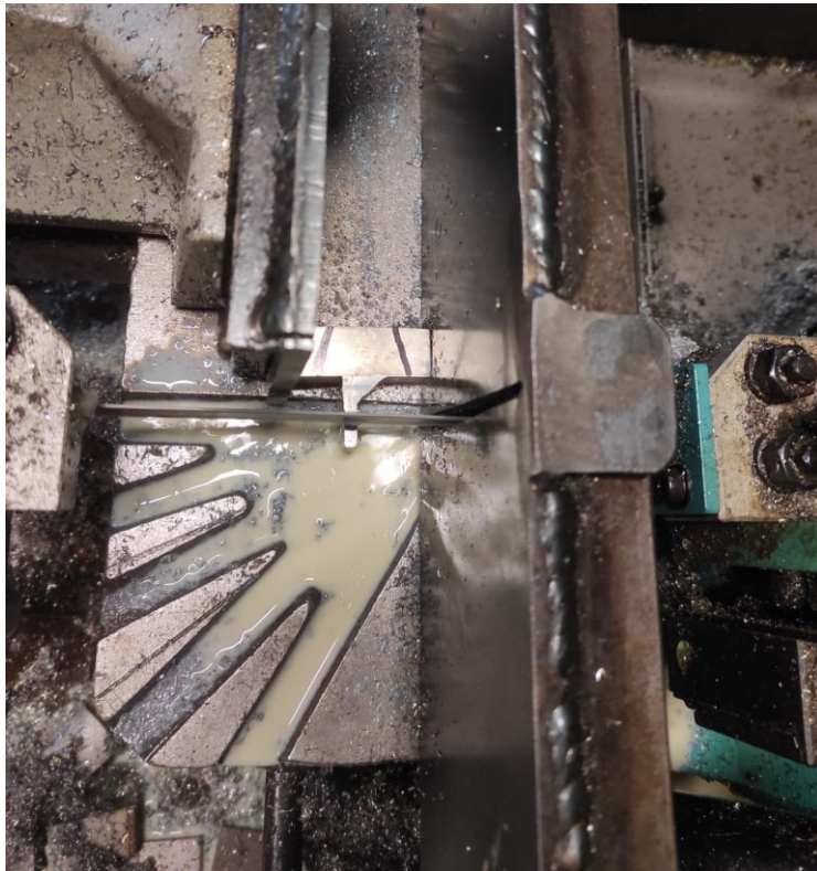
Slika 13. Izrezivanje uzorka (stijenka cijevi)
