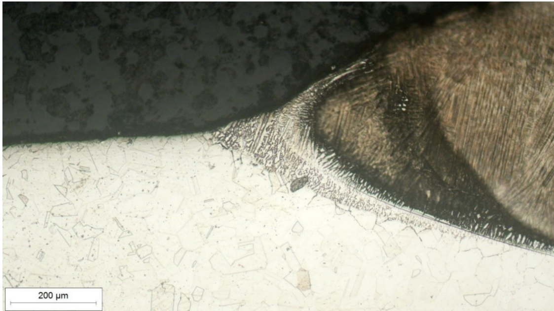
Slika 29. Zona utjecaja topline sa strane ploče snimljena pri povećanju 100×
