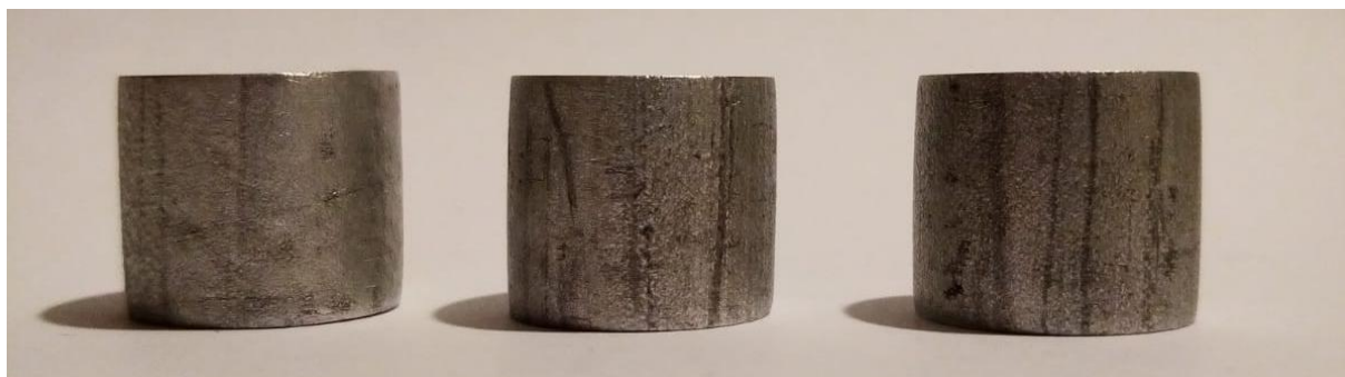
Slika 23. Uzorci nakon deformacije gdje su kontaktne površine bile glatke
