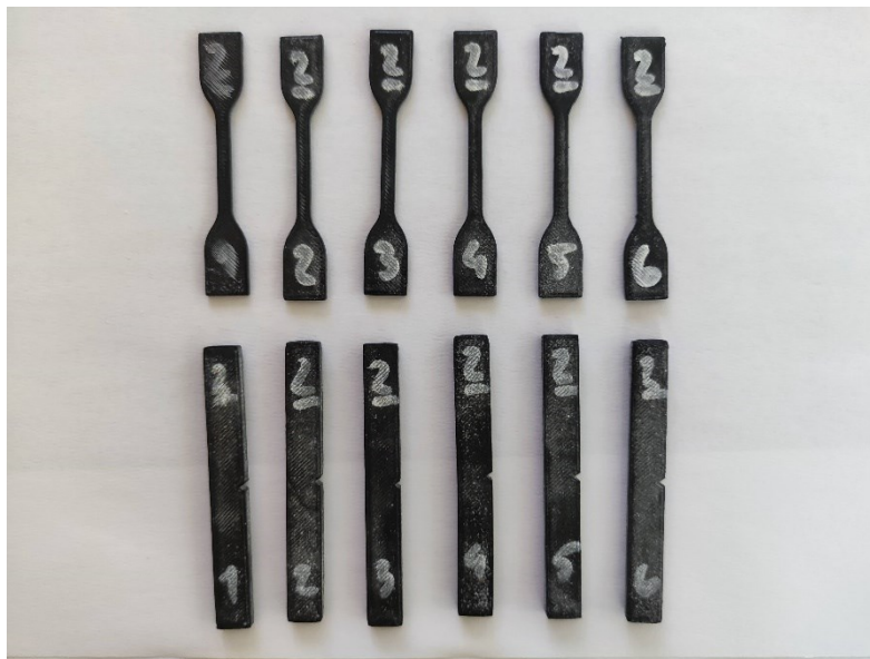
Slika 14: Epruvete 2. serije - sol pri 170 °C
