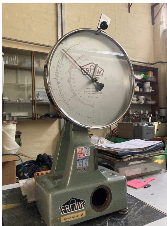
Slika 24: Uređaj marke Frank za ispitivanje udarne žilavosti
