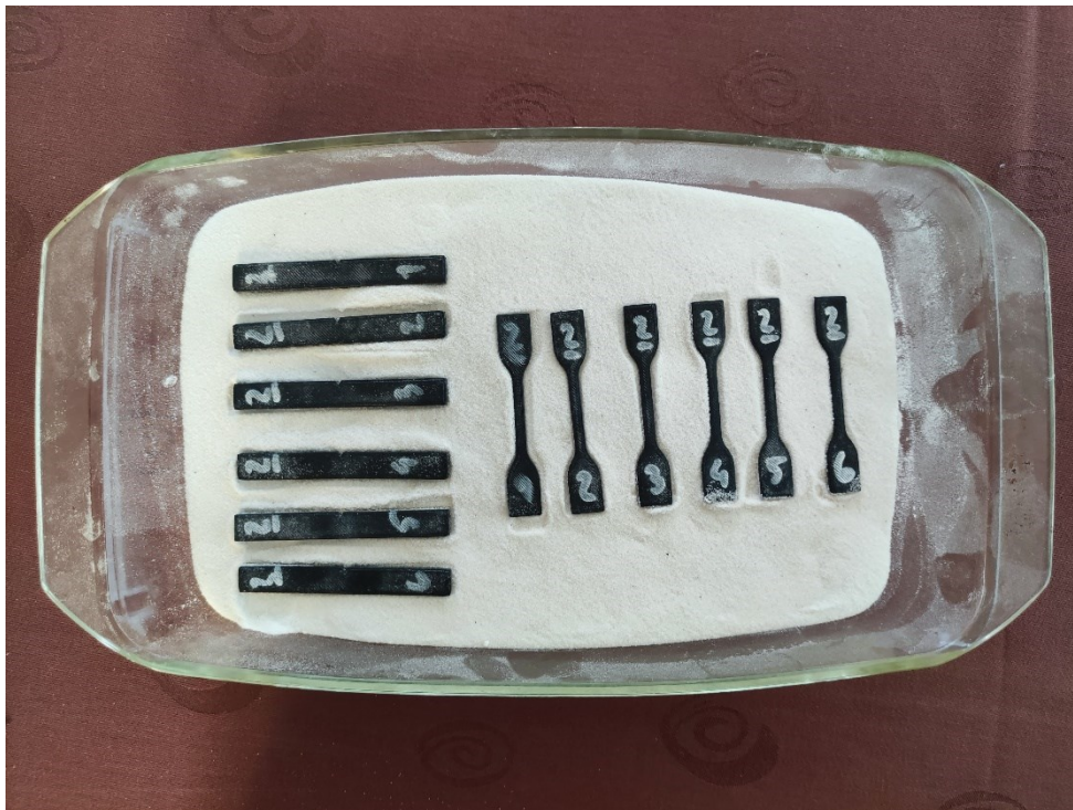
Slika 12: Položaj epruveta u posudi sa soli
