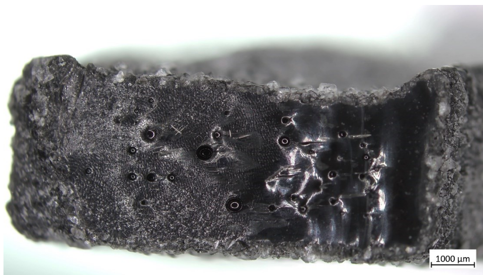
Slika 39: Primjer serije 4 - presjek nakon rasteznog pokusa
