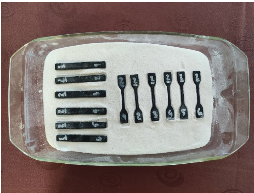
Slika 12: Položaj epruveta u posudi sa soli
