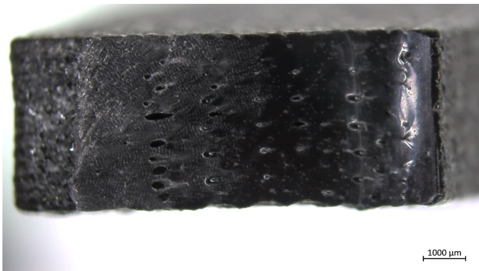
Slika 35: Primjer epruvete 2 - presjek nakon rasteznog pokusa
