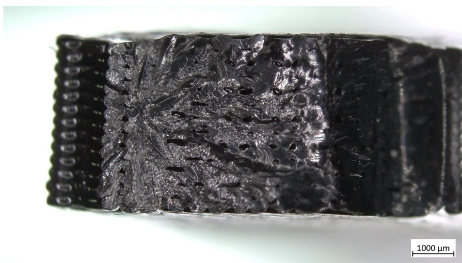
Slika 37: Primjer serije 3 - presjek nakon rasteznog pokusa
