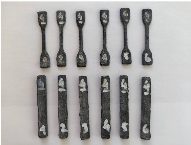
Slika 16: Epruvete 4. serije - sol pri 235 °C
