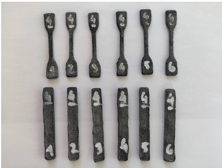
Slika 16: Epruvete 4. serije - sol pri 235 °C
