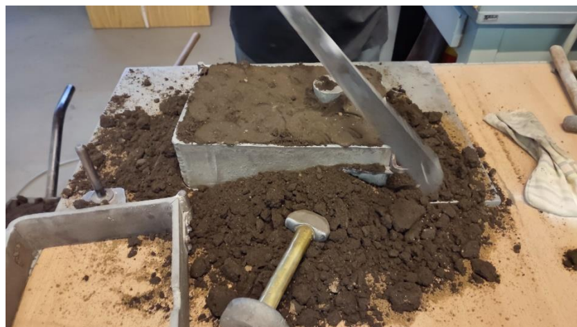
Slika 45. Poravnavanje kalupne mješavine
