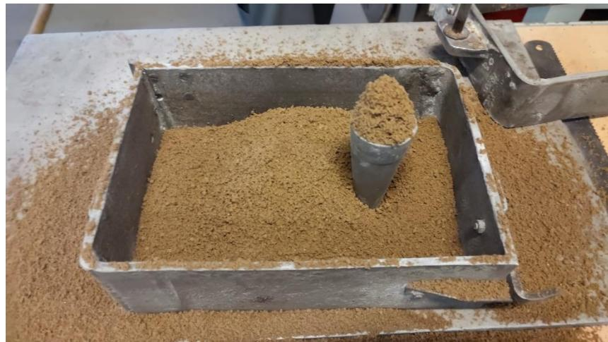
**Slika 43. Stavljanje modelne kalupne mješavine**
