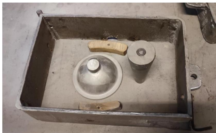
Slika 41. Položaj uljevnog sustava
