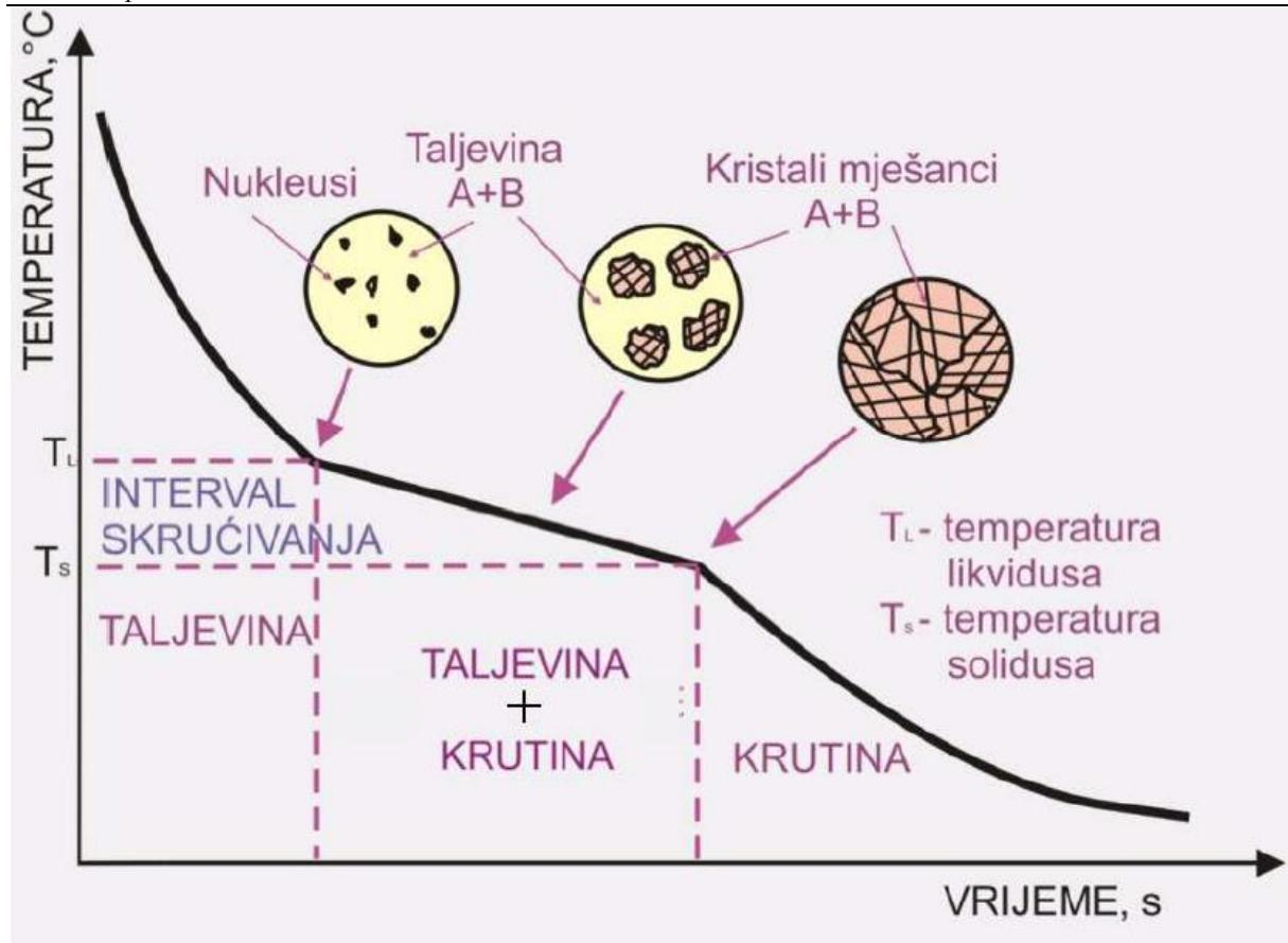
Slika 7. Shematski prikaz krivulje hlađenja dvokomponentne legure [5]
