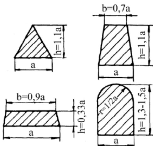
**Slika 23. Različiti oblici poprečnog presjeka razvodnika [5]**
