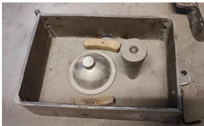
Slika 41. Položaj uljevnog sustava
