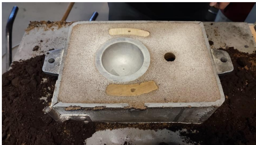
Slika 46. Model poklopca i razvodnika u gornjaku
