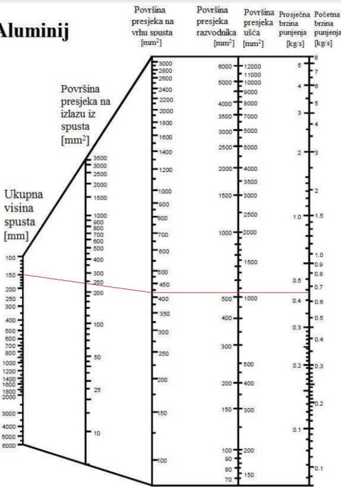
Slika 28. Određivanje dimenzija uljevnog sustava [13]
