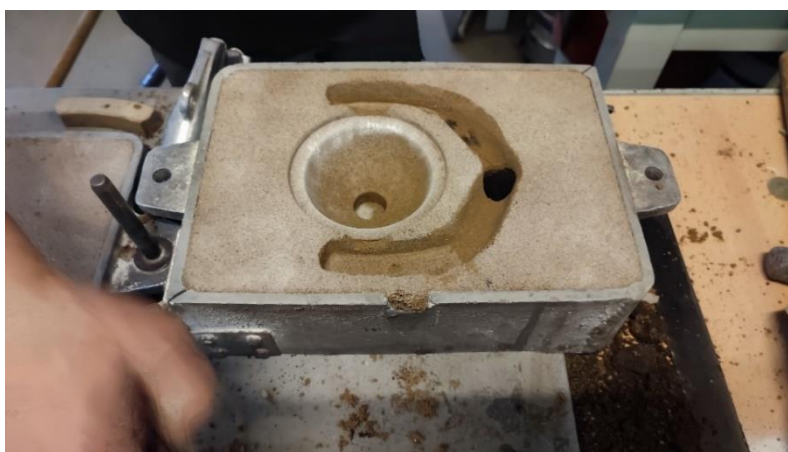
Slika 50. Izrada razvodnika i ušća
