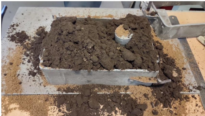
Slika 44. Stavljanje punidbene kalupne mješavine
