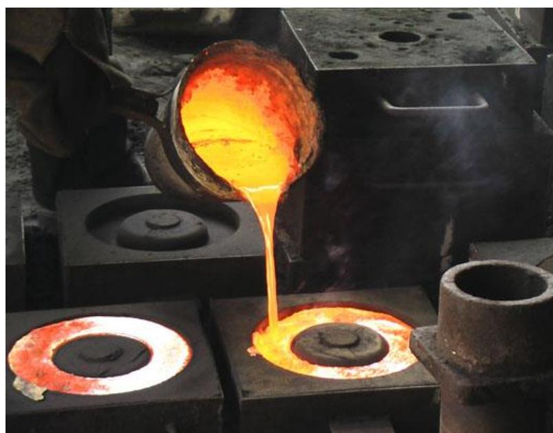
Slika 1. Lijevanje u kokilu [2]
