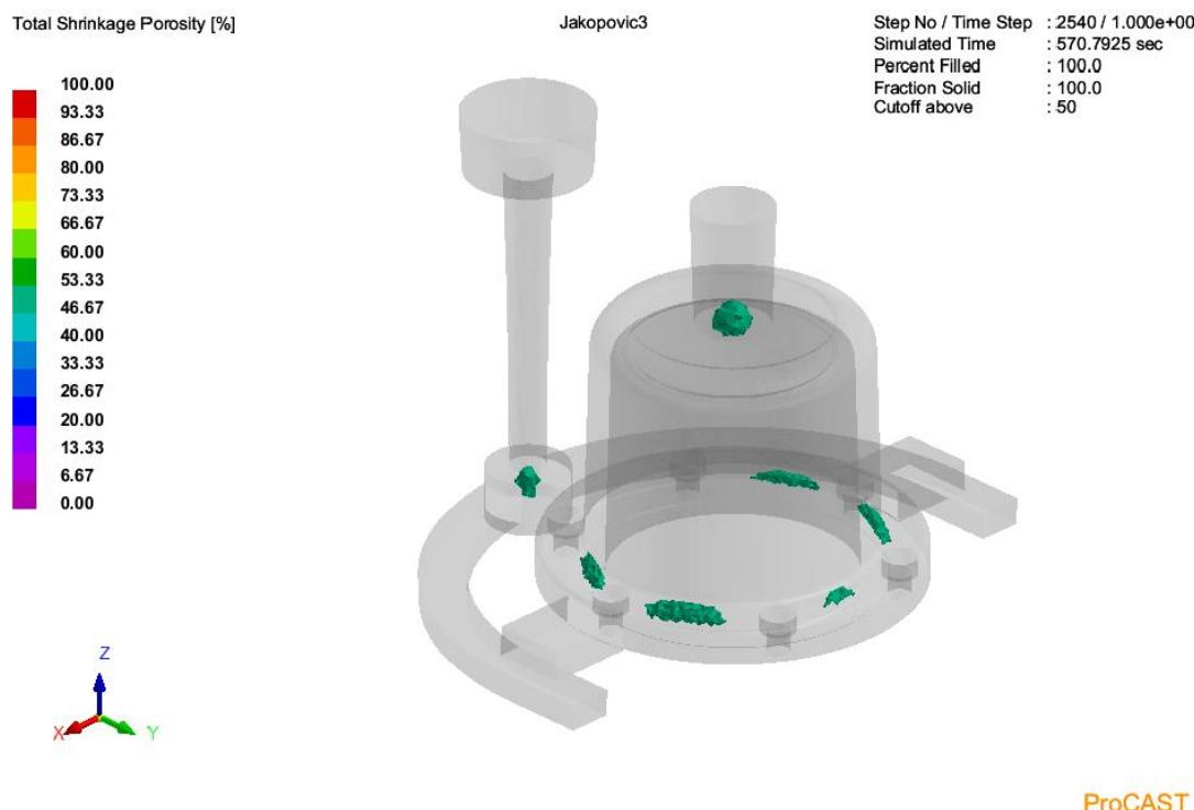
**Slika 34.** Pojava poroznosti u primjeru s premalim pojilom
