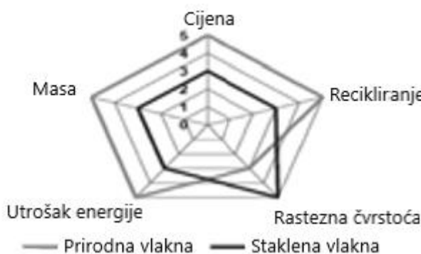
Slika 6. Usporedba prirodnih i staklenih vlakana [5]
