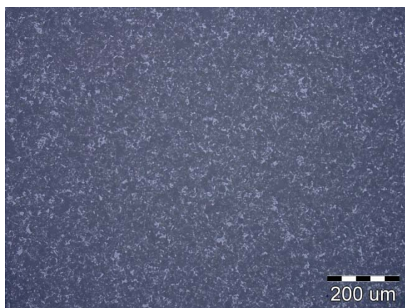
Slika 15. Površina uzorka nakon 5. faze brušenja
