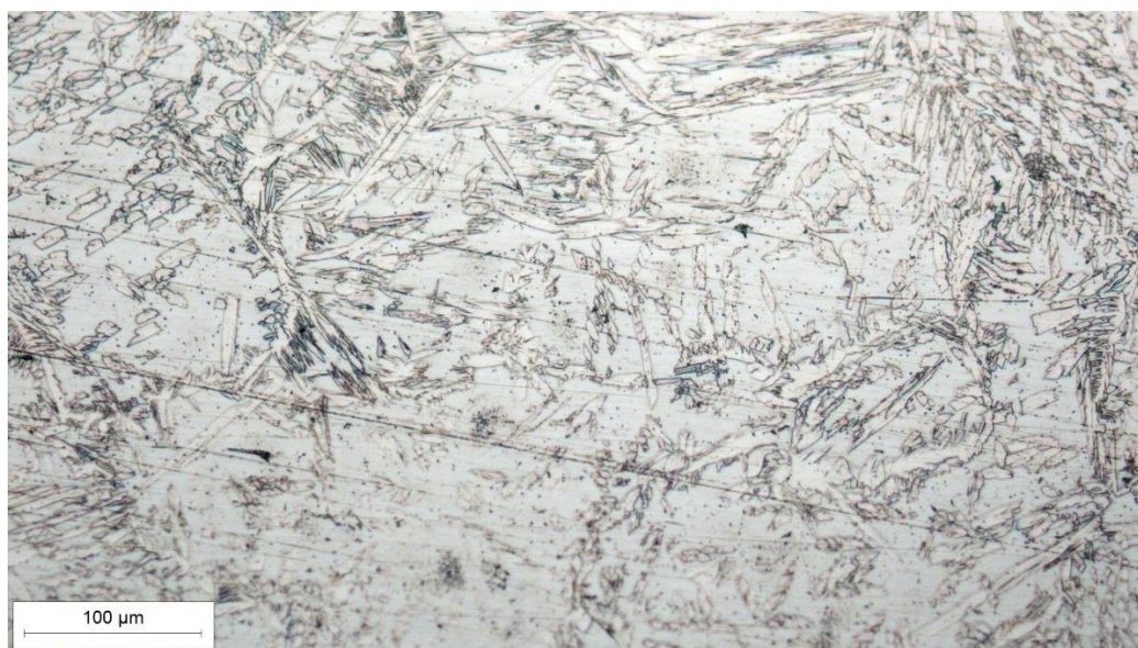
Slika 38. Mikrostruktura navara uzorka 1B uz povećanje 200x
