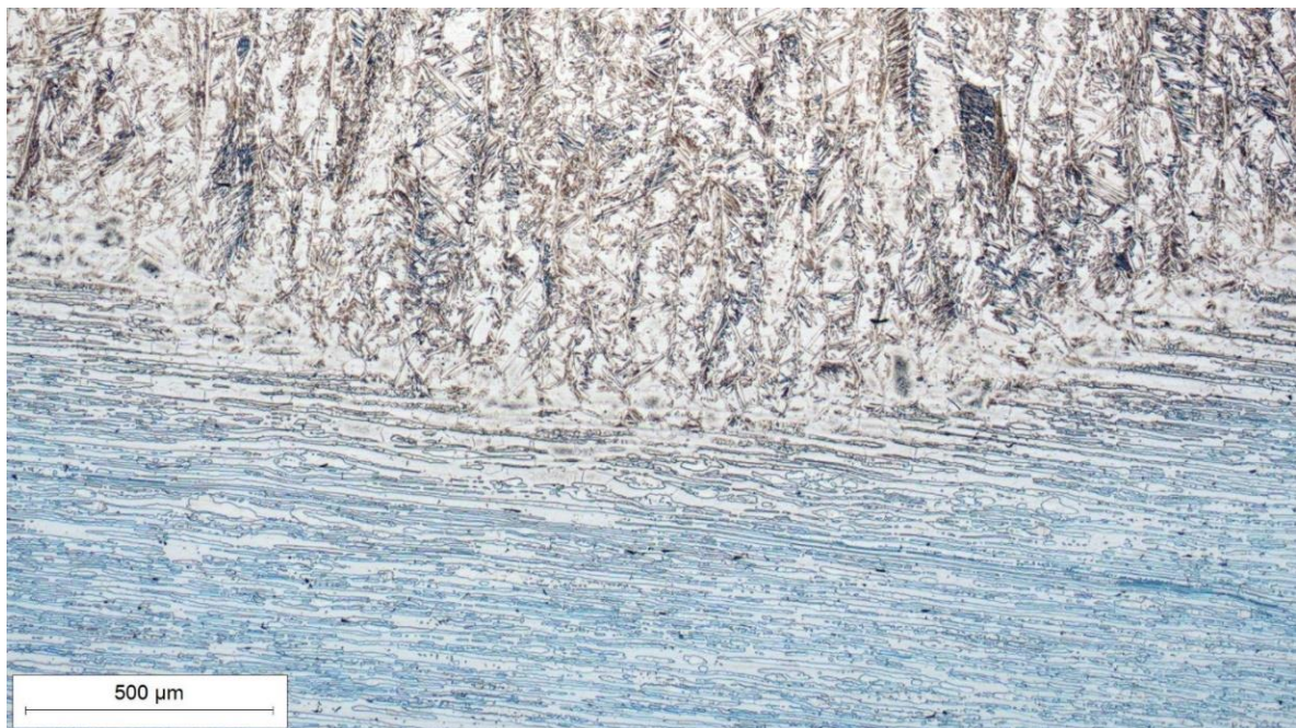
Slika 42. Mikrostruktura korijena navara uzorka 1B uz povećanje 50x
