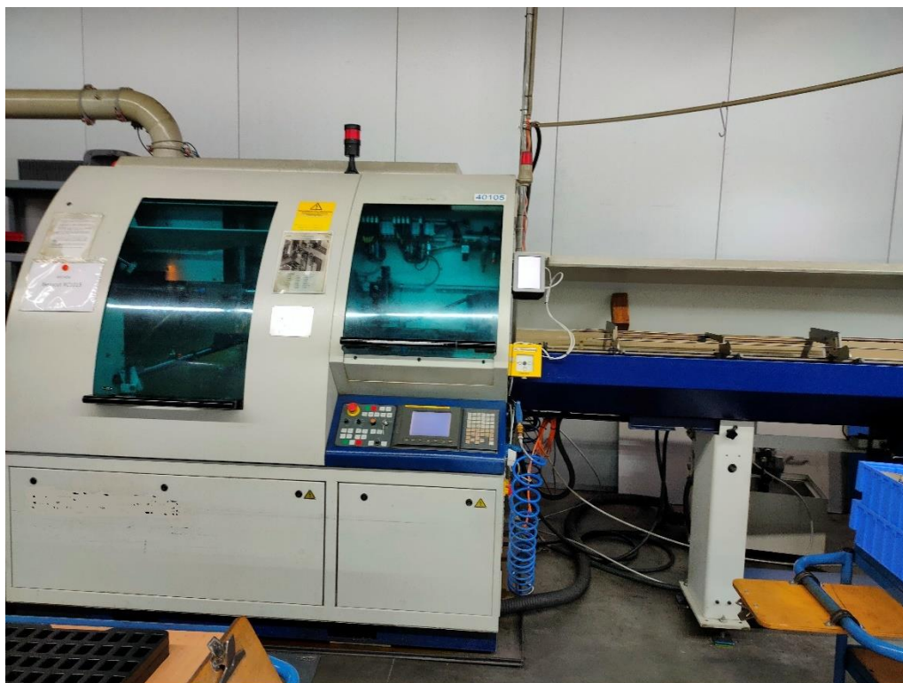
Slika 20. Tokarski obradni centar Tornos EvoDECO 16/10 s automatskim dodavačem šipki
