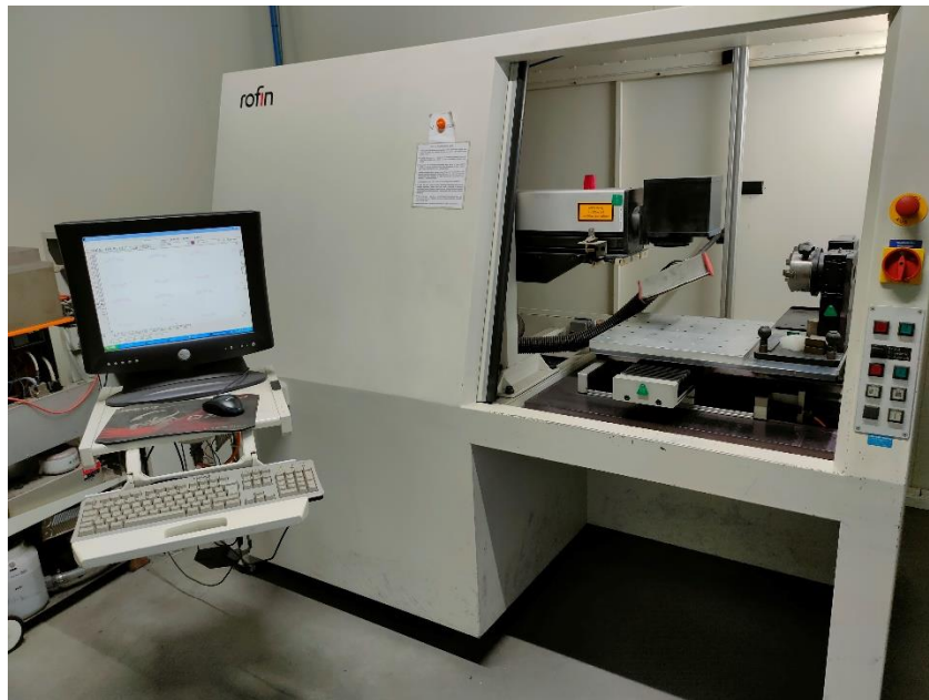
Slika 41. Uređaj za lasersko označavanje pločice
