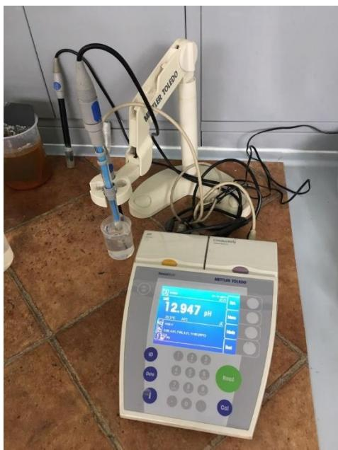
Slika 9. pH-metar-konduktometar
