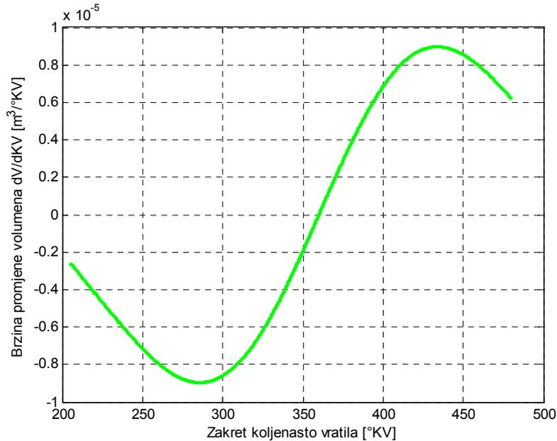
Slika 5. Brzina promjene volumena cilindra  $dV_c / d\alpha$ .
