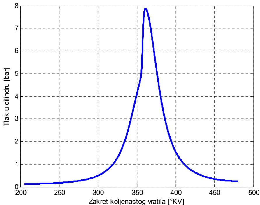
Slika 3. Eksperimentalne vrijednosti tlaka  $p_c$  u cilindru pri  $n=1200 \text{ min}^{-1}$  i  $\lambda_Z = 4,17$
