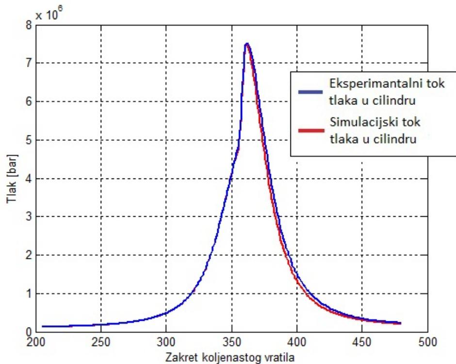
Slika 18. Usporedba vrijednosti toka tlaka u cilindru dobivene simulacijskim proračunom i eksperimentalnim ispitivanjem 1.
