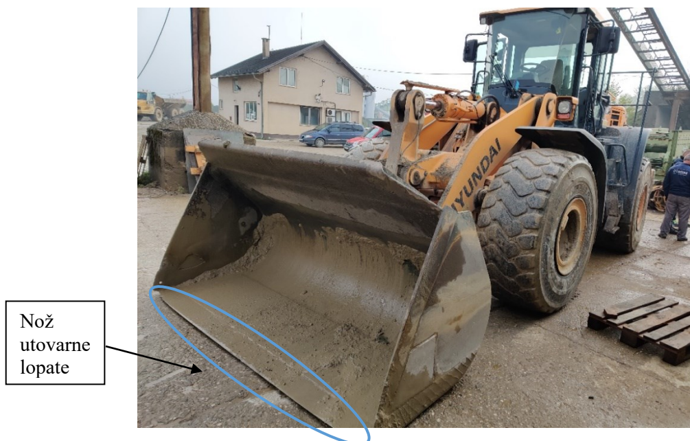
Slika 15. Utovarivač Hyundai HL770-9A sa utovarnom lopatom opće namjene sa nepotrošenim nožem
