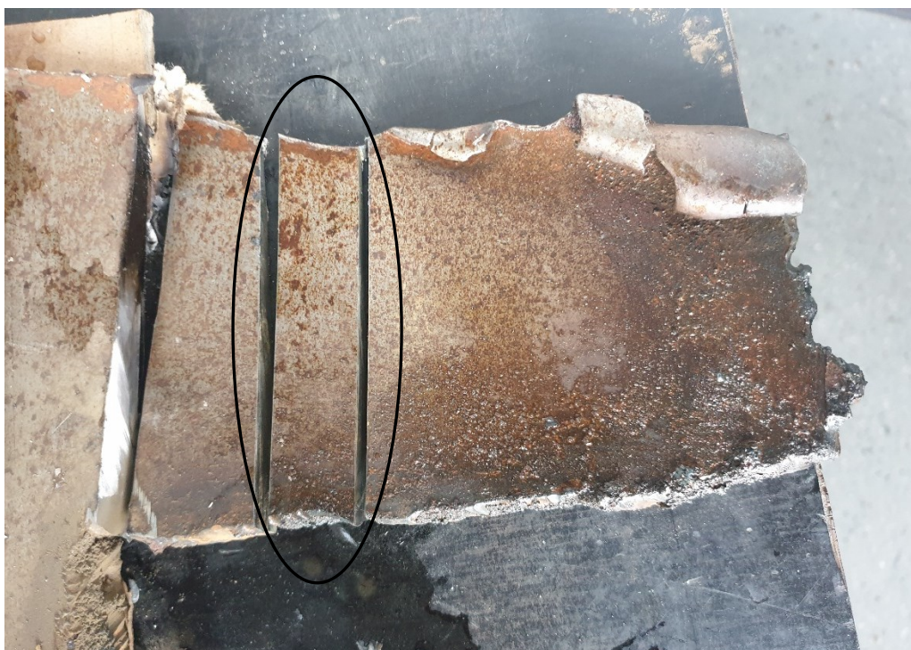
Slika 18. Odrezani uzorak utovarne lopate
