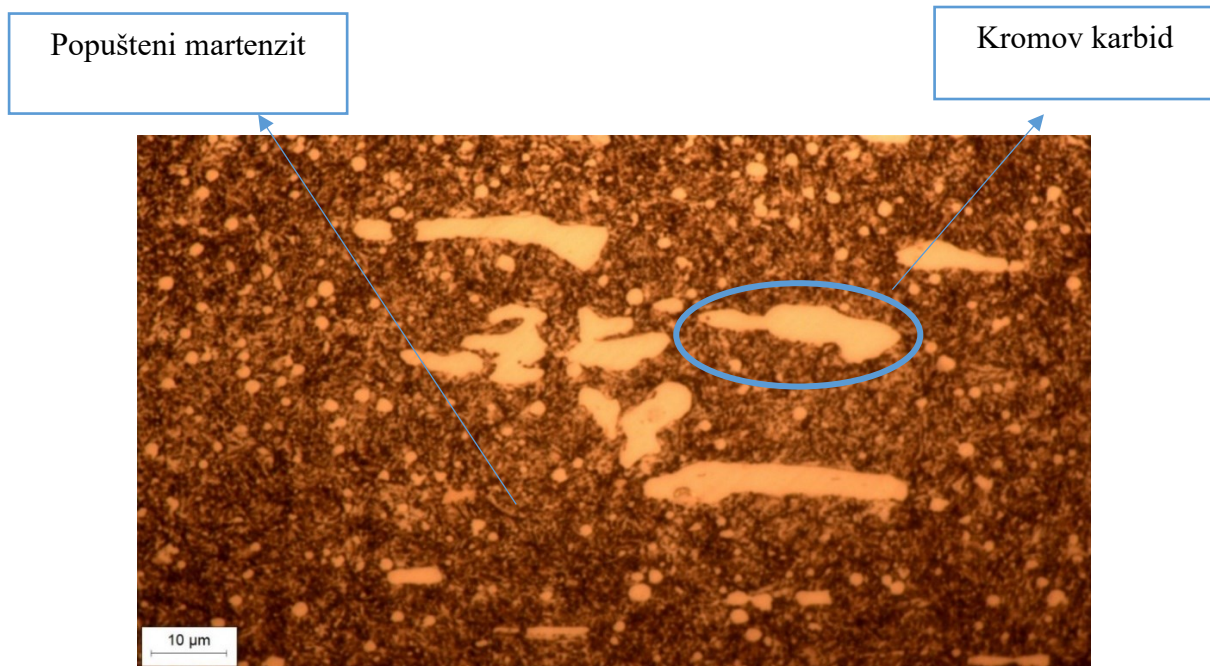
Slika 10. Mikrostruktura jezgre uzorka noža, povećanje 1000x
