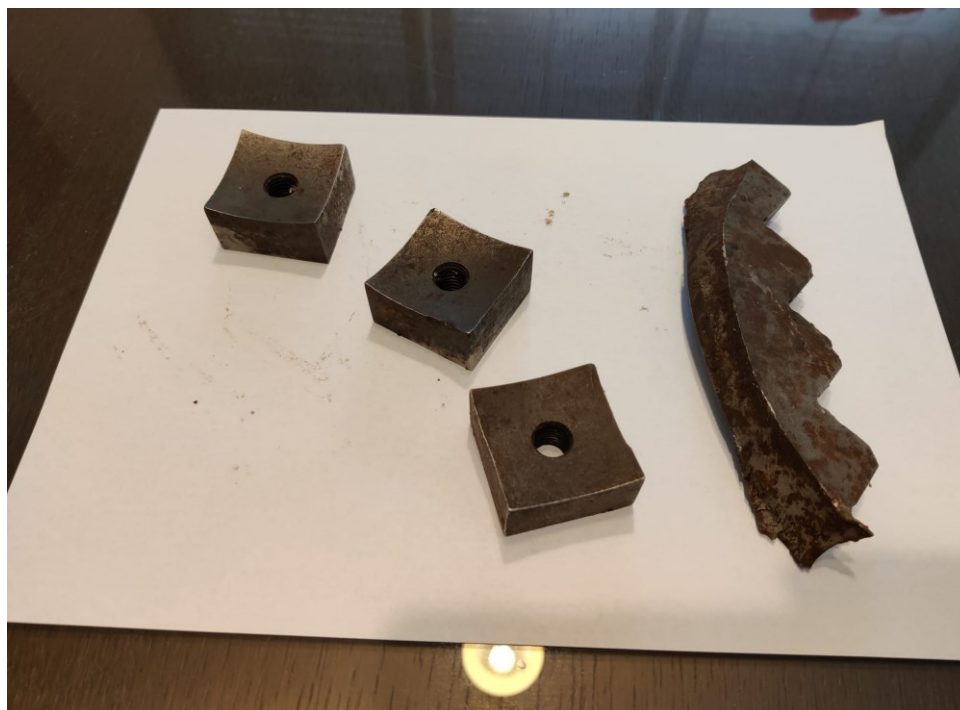
Slika 6. Primjer noževa za obradu plastike
