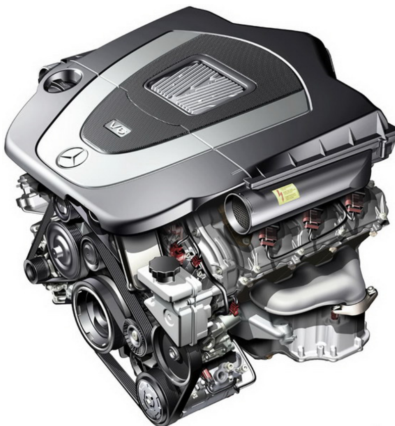
Slika 5.64. Mercedes-ov motor V6-90°, KV 90(+30), M272 E35 [9]
