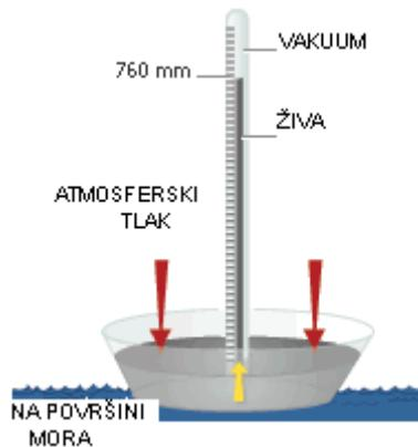
*Slika 2 - Torricelliev barometar*
