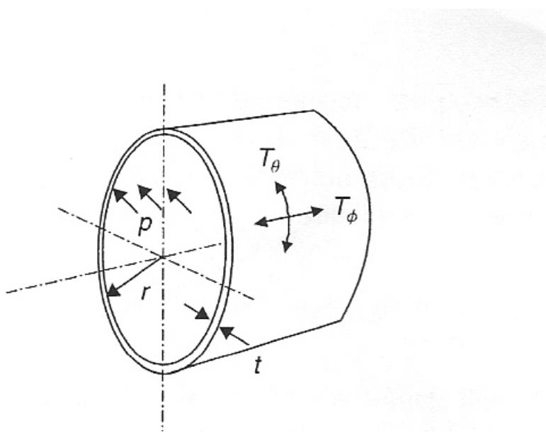
Slika 5 Segment cirkularne cijevi sa unutarnjim pritiskom
