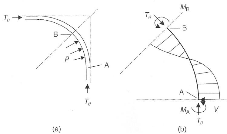
Slika 14 [1] *Deformacija brida cijevi u postupku hidrooblikovanja sa niskim tlakom (a) djelujuće sile, (b) dijagram momenta savijanja na luku AB*
