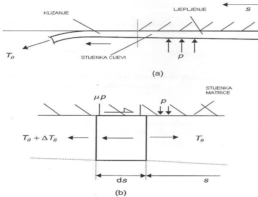
Slika 8 (a) Dio cijevne stjenke u kontaktu sa matricom tijekom deformiranja cijevnog u kvadratni profil
