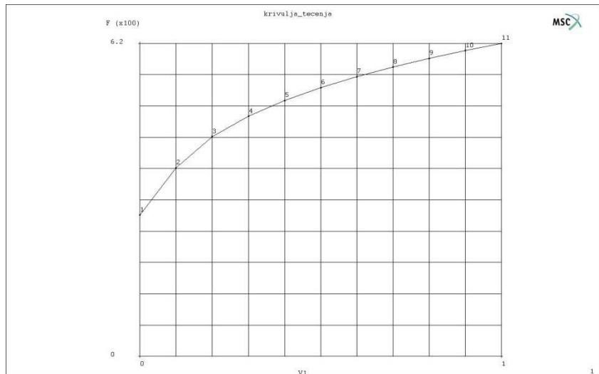
Slika F4. Krivulja tečenja za Č 0432. Zadana izrazom :  $k_f = 620 \varphi_{ekv}^{-0.22} \text{ MPa}$
