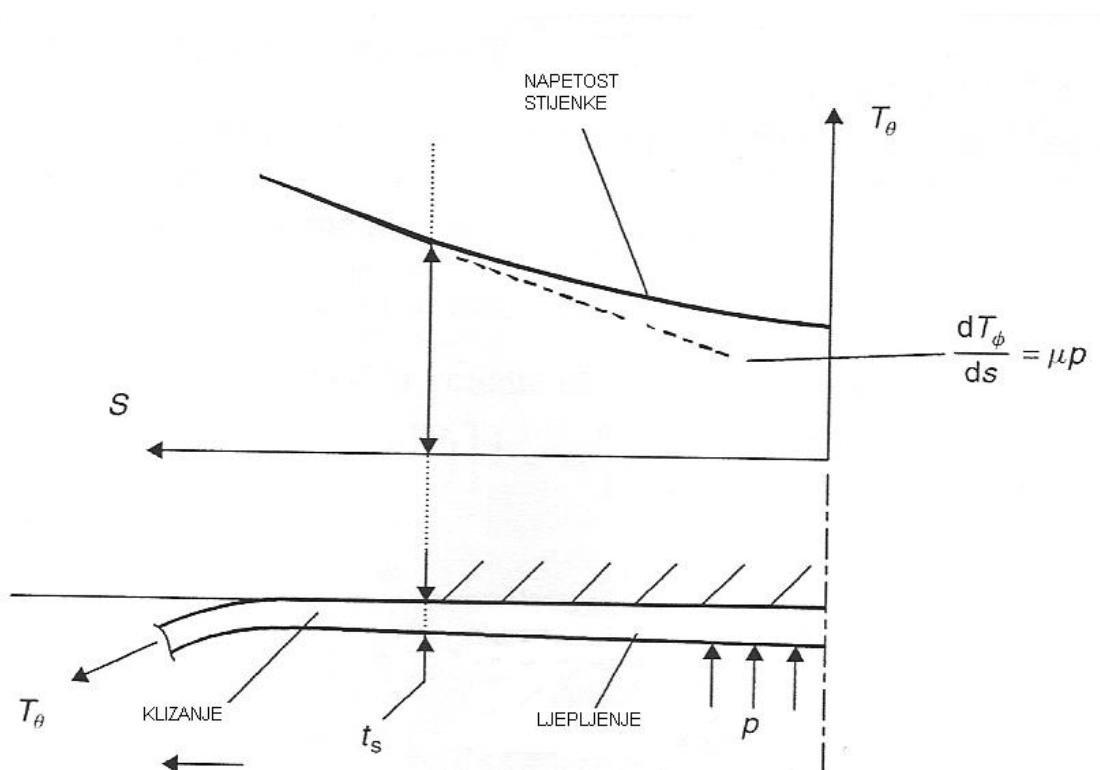
Slika 9 [1] Raspodjela linijskog naprezanja u dijelu cijevi koji je u kontaktu sa stjenkom cijevi tijekom preoblikovanja okrugle cijevi u kvadratni dio
