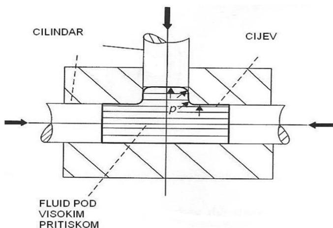
Slika 3 Hidrooblikovanje cijevi pritiskom i aksijalnom silom
