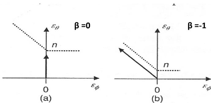
Slika 10 Trajektorije deformacije za (a) ravninsko stanje deformacija,
