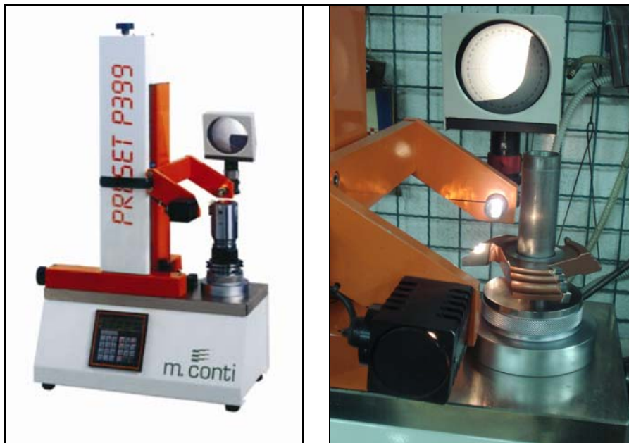
Slika 3.18 Preset uređaj za kontrolu i mjerenje alata
