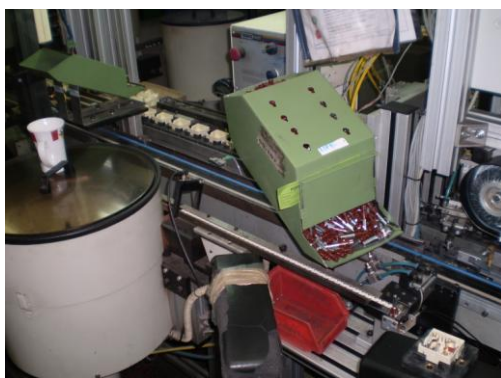
Slika 17. Vibrodođavač s gredom
