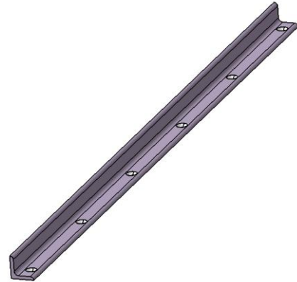
Slika 23. L-profil grede vibrododavača desni
