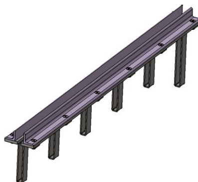
Slika 25. Sklop grede vibrododavača
