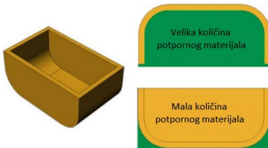
Slika 28. Utjecaj orijentacije proizvoda na količinu potpornog materijala [14]
