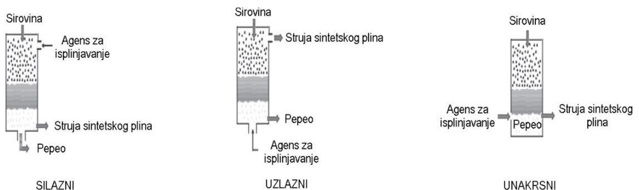
Slika 8. Sheme isplinjača s fiksnim slojem [42]
